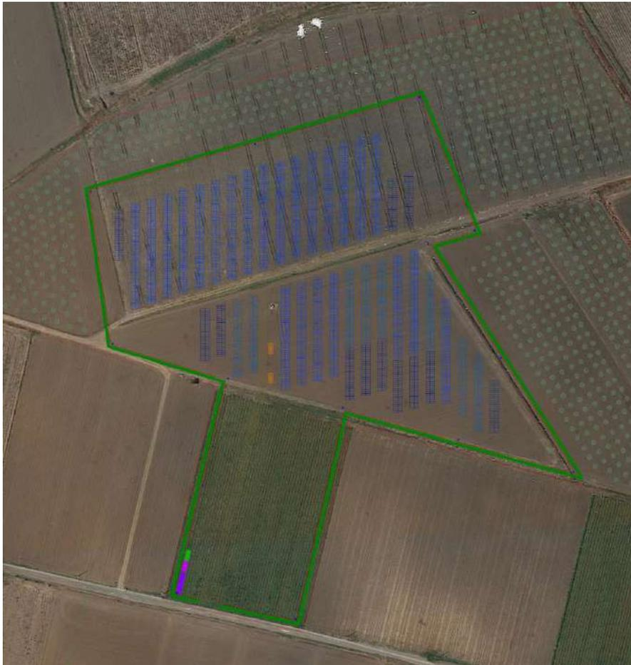
Figura 4-18 - Ortofoto sotto-impianto FV-Restinco, in blu le aree adibite all'installazione dei moduli fotovoltaici (fonte dell'ortofoto: Google Earth anno di acquisizione dell'immagine 2021)
