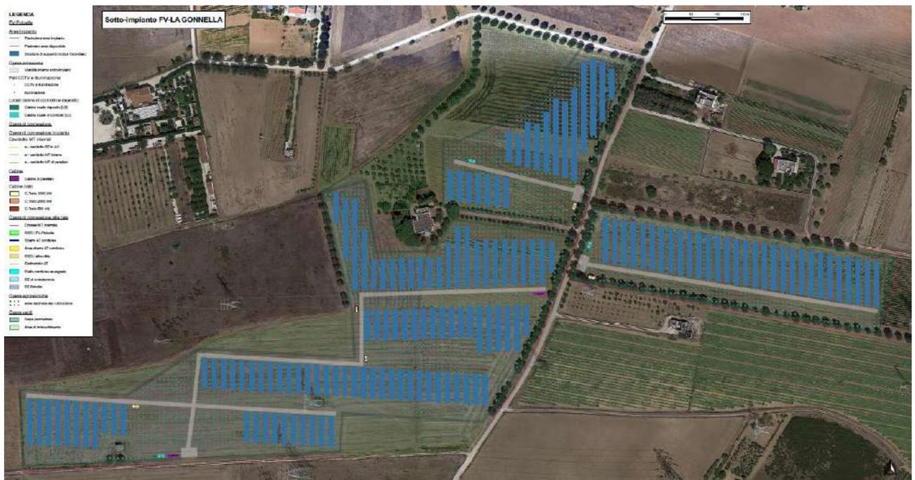
Figura 9-15 - Layout agro-fotovoltaico sotto-impianto FV-La Gonnella
