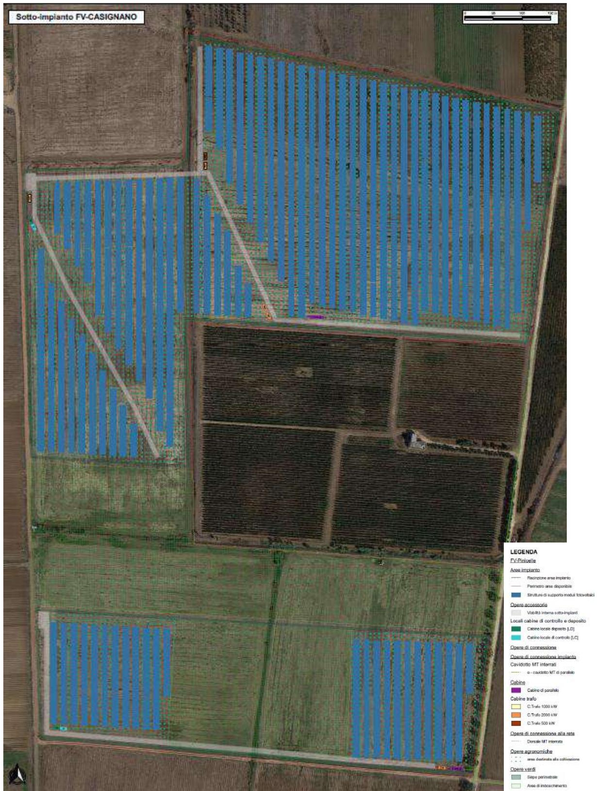
Figura 9-11 - Layout agro-fotovoltaico sotto-impianto FV-Casignano
