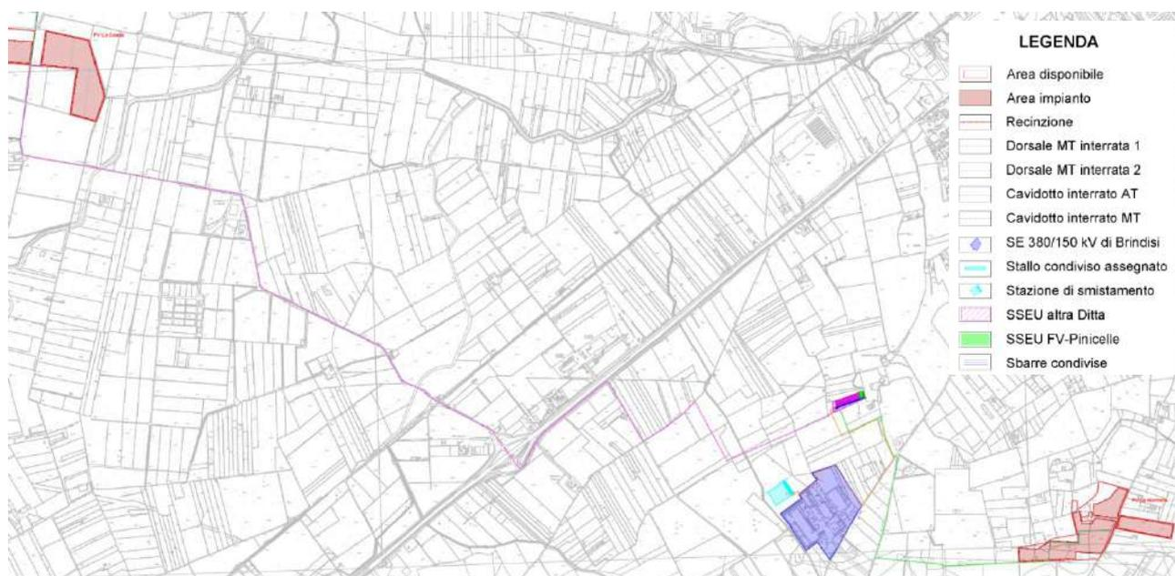
Figura 4-23 - Schema di convogliamento dell'energia dalle cabine di parallelo ubicate rispettivamente nei sotto-impianti FV-La Gonnella e FV-Lo Spada alla Sottostazione Elettrica Utente 150/30 kV (SSEU FV-Pinicelle) e da questa allo stallo condiviso assegnato, da realizzare in una futura stazione di smistamento 150 kV da costruire nelle immediate vicinanze della Stazione di Trasformazione 380/150 kV "Brindisi"
