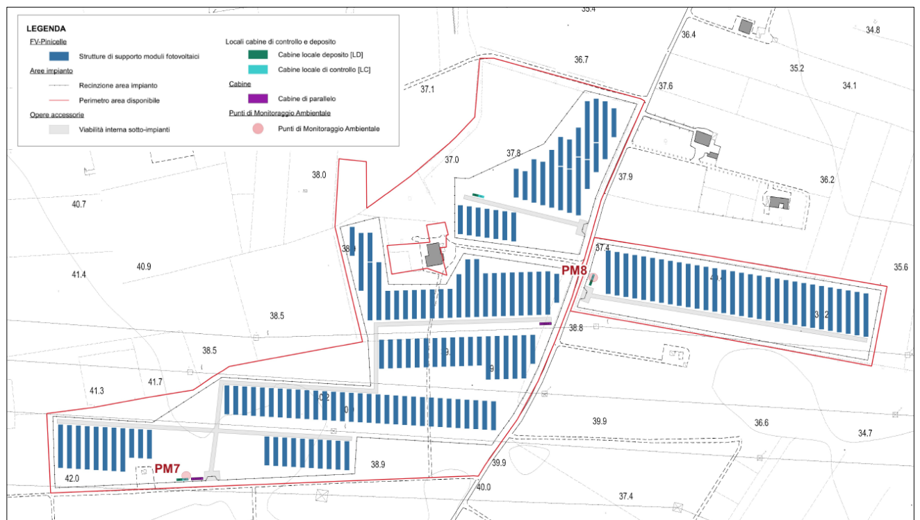
Figura 3-5 - Individuazione dei punti di monitoraggio ambientale (PM7 e PM8) ubicati nel sotto-impianto FV-La Gonnella
