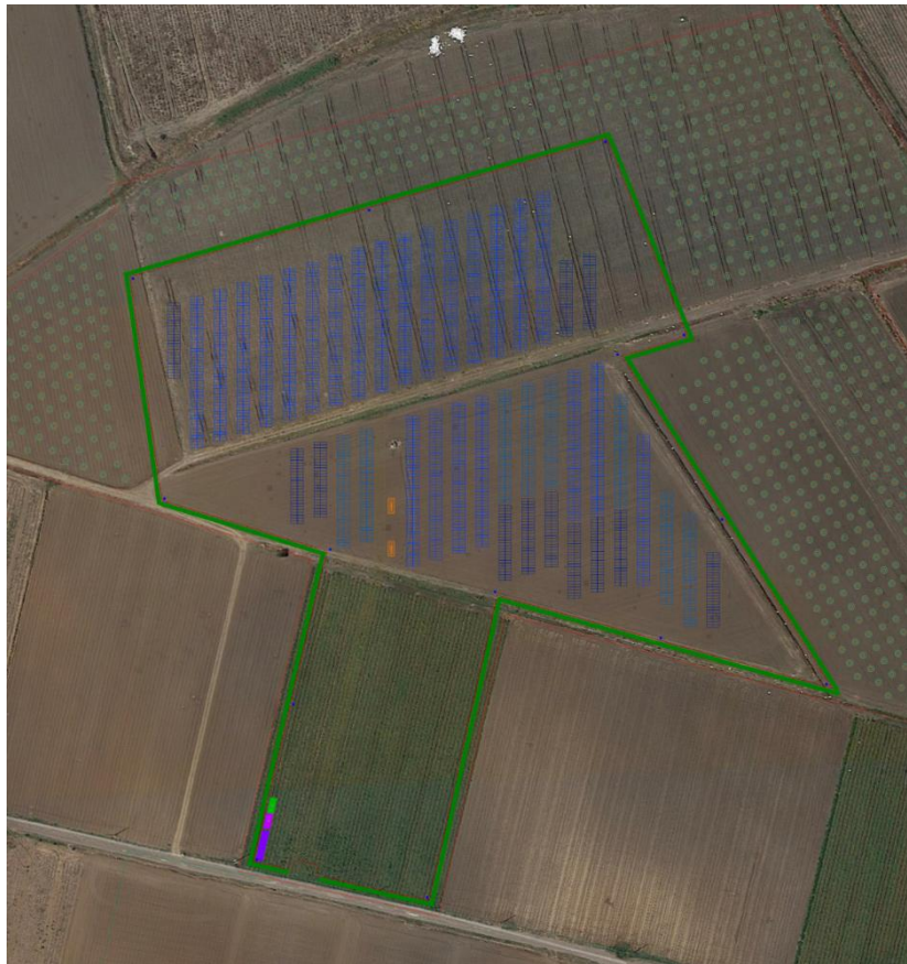
Figura 2-15 - Ortofoto sotto-impianto FV-Restinco, in blu le aree adibite all'installazione dei moduli fotovoltaici (fonte dell'ortofoto: Google Earth anno di acquisizione dell'immagine 2021)
