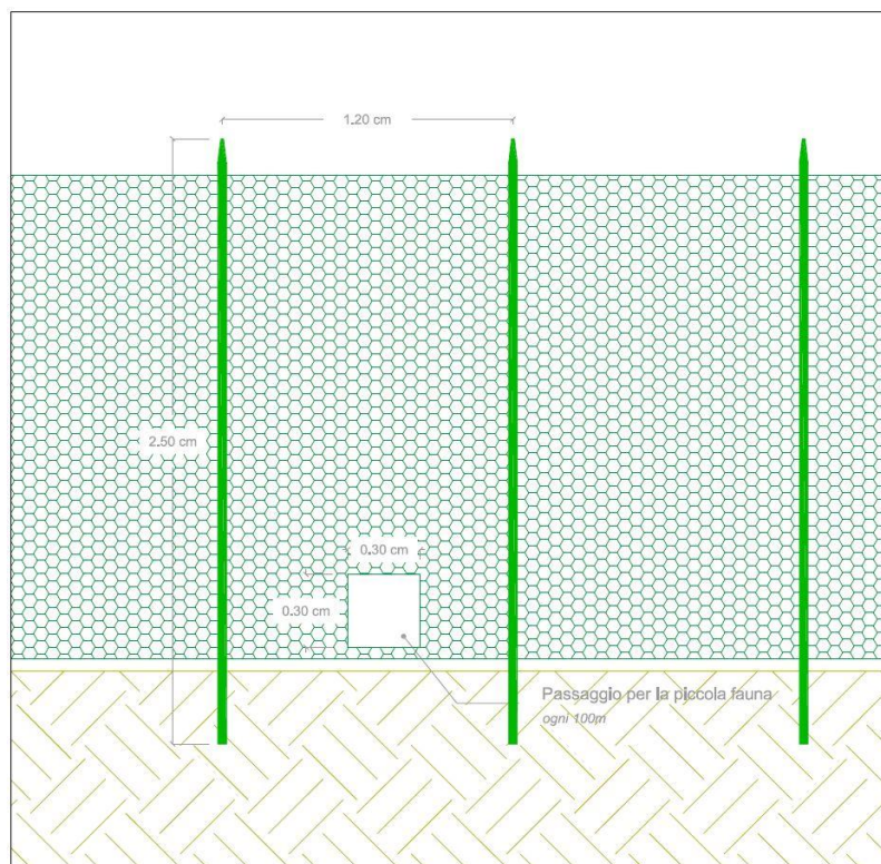
Figura 5-2 - Particolare recinzione passaggio piccola fauna
