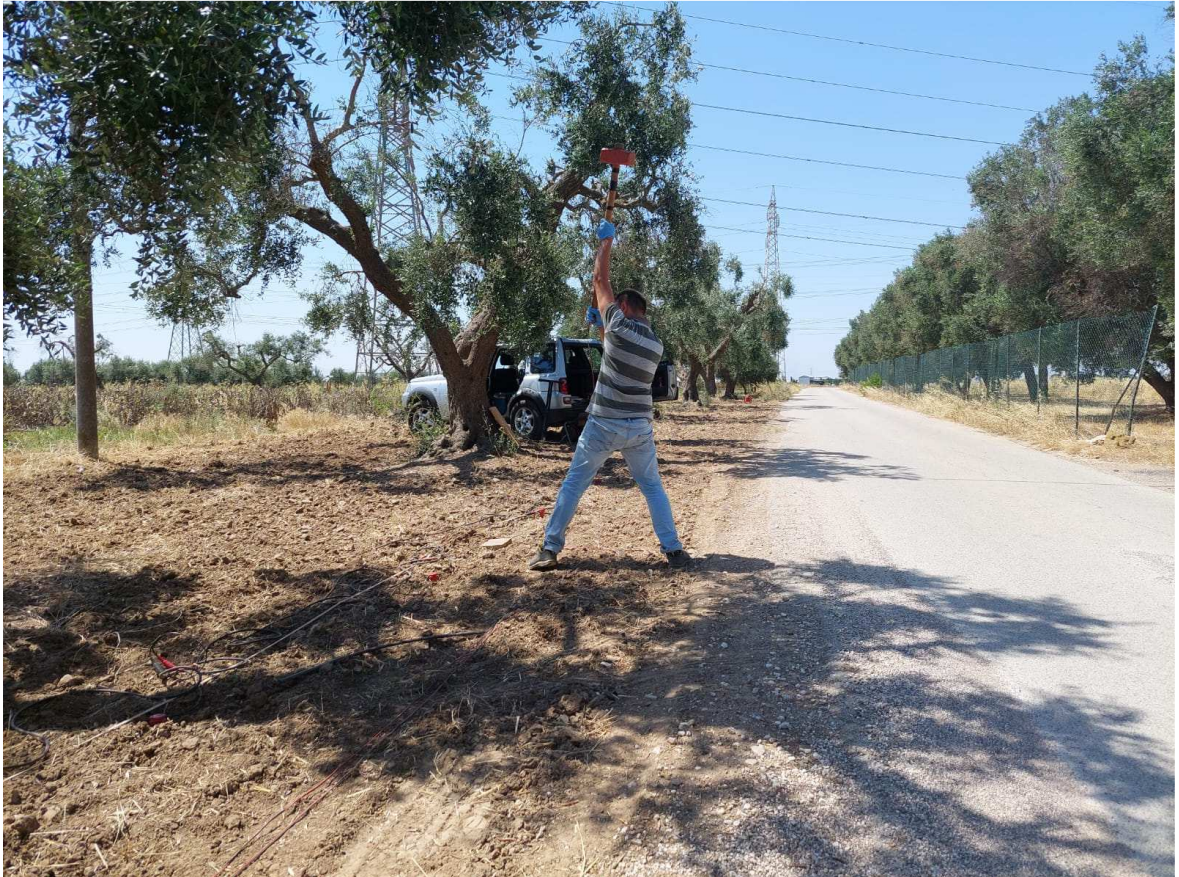
Foto 6: Fase di esecuzione della Rifrazione (C-C')
