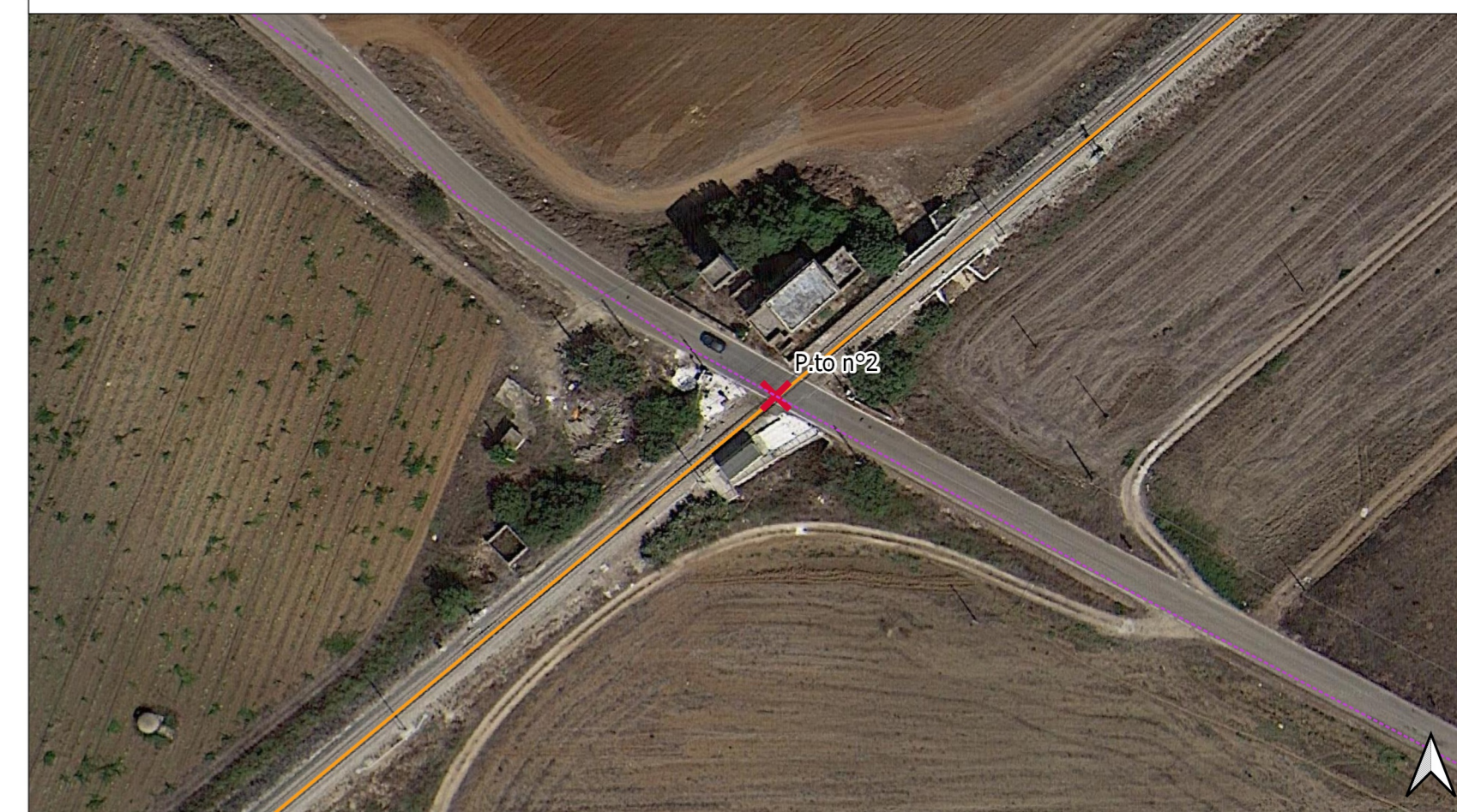
DETTAGLIO p.to n°2 Interferenza di attraversamento con TOC della dorsale interrata in MT di collegamento alla SSEU con la rete ferroviaria esistente scala 1:1.000
