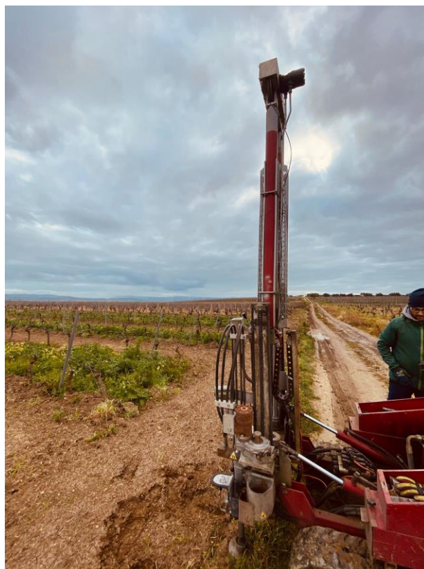
Fig. 22: Fotografia del sito d'indagine DPSH
