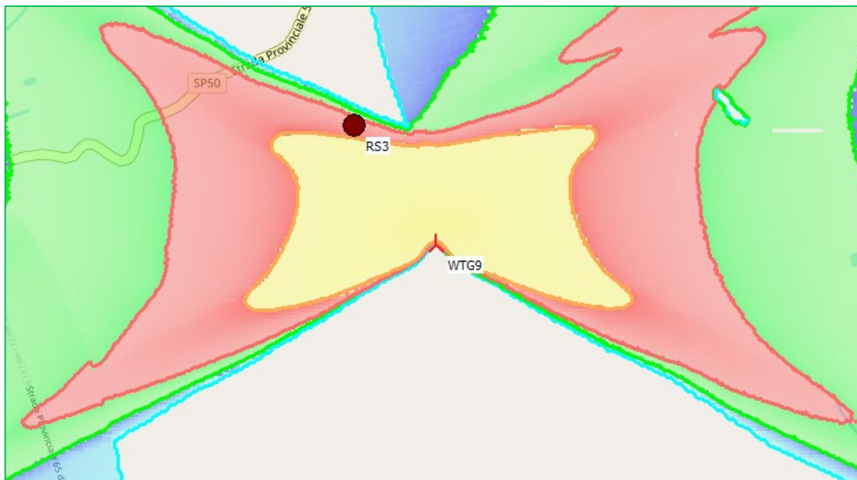
Figura 6 - posizione recettore sensibile RS3 all'interno dell'area di ombreggiamento intermittente dell'impianto WTG9
