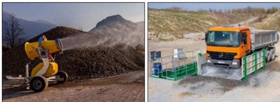
Figura 4 - Esempio di Impianto di nebulizzazione mobile (immagine a sx) e di lavaggio ruote [Fonte:web]
