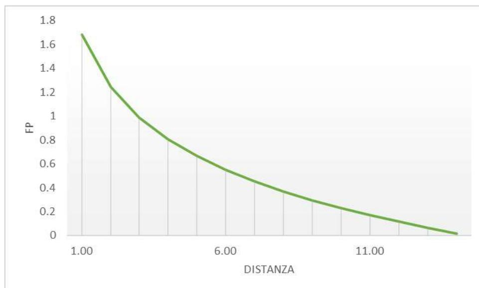
In definitiva si ottiene l'indice azimutale pesato pari al prodotto tra l'indice  $I_a$  e il fattore di peso per distanza:
