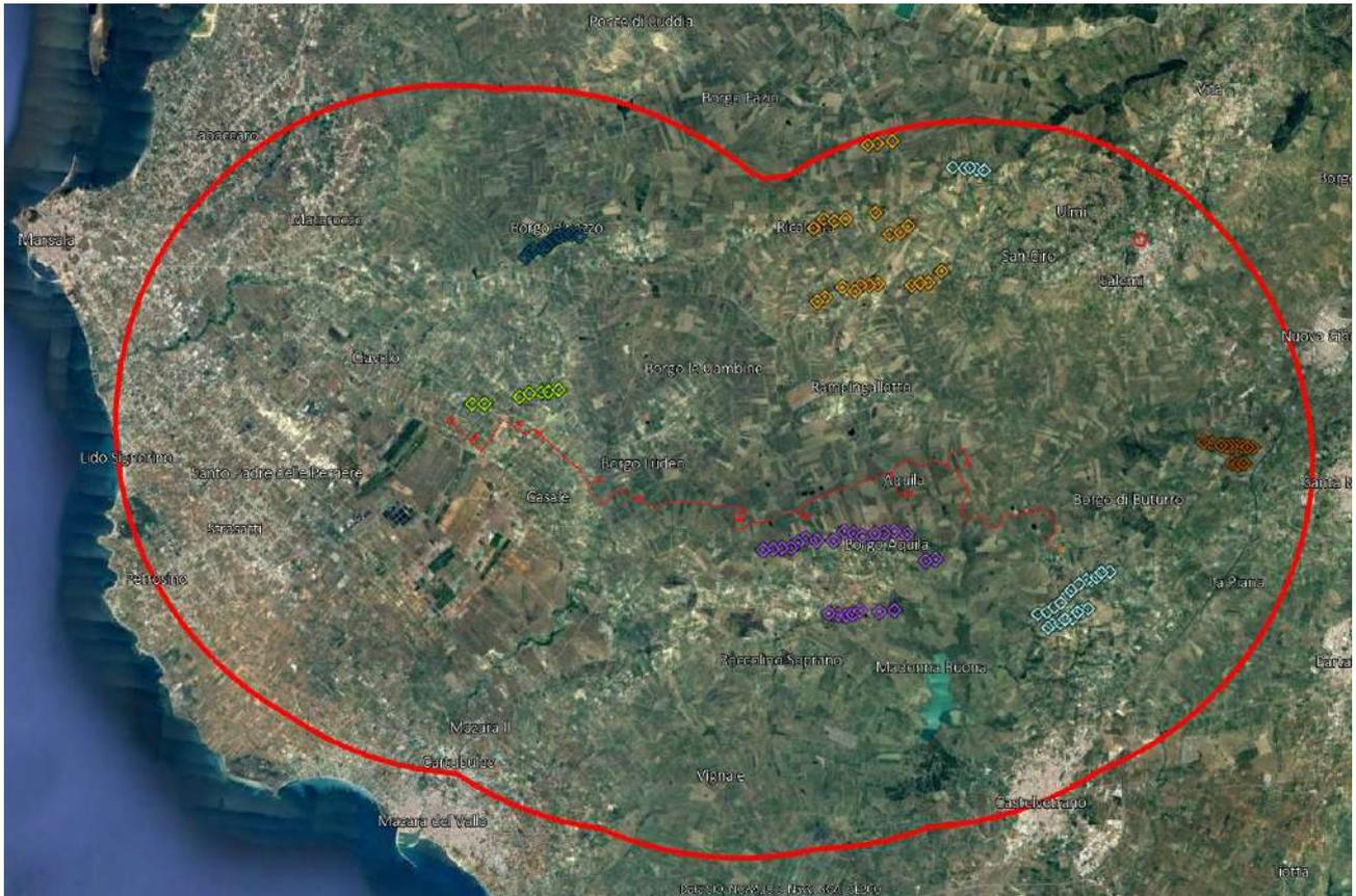
*Figura 24 - Inquadramento degli impianti eolici esistenti nell'area vasta analizzata*
