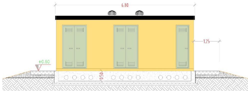
Figura 8 - Particolare Prospetto Frontale Cabina Ausiliaria
