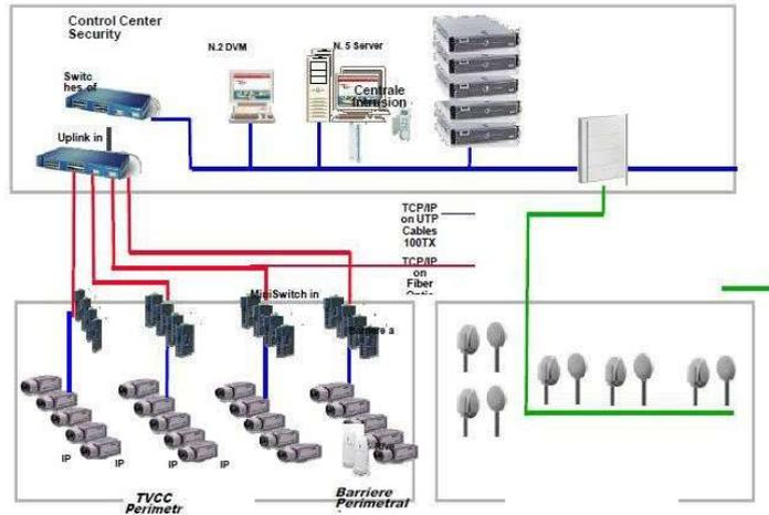
Figura 2 – Schema del Sistema di sorveglianza
