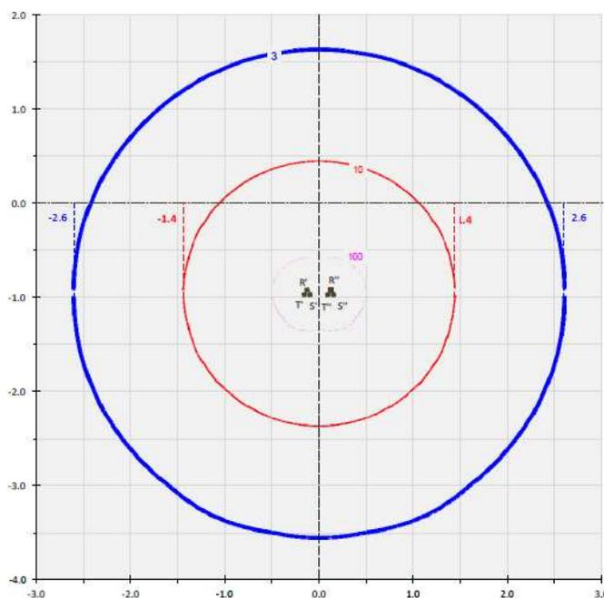
Figura 10 - Curve di equilivello per il campo di induzione magnetica generato da una linea MT posata a trifoglio ( $I_{max}=710\text{A}$ ; formazione (3x1x630))
