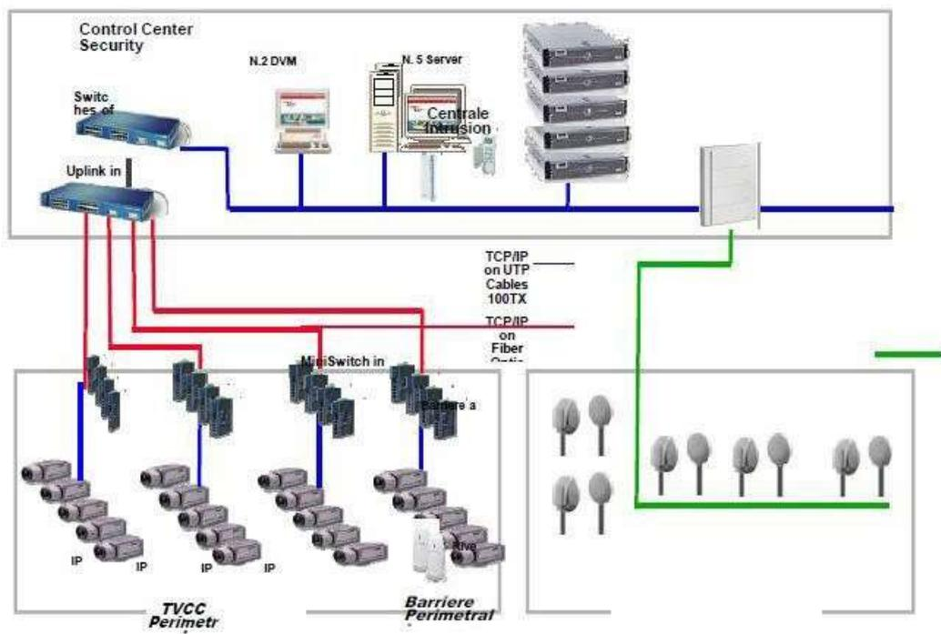
Figura 1 – Schema del Sistema di sorveglianza
