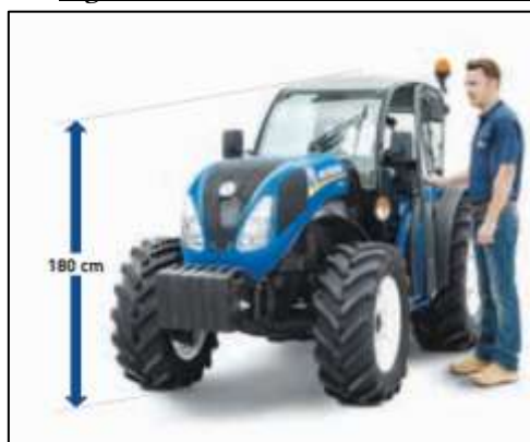
Figura 8.1: Dimensioni caratteristiche di un trattore da frutteto con cabina ribassata (Fonte: CNH)
