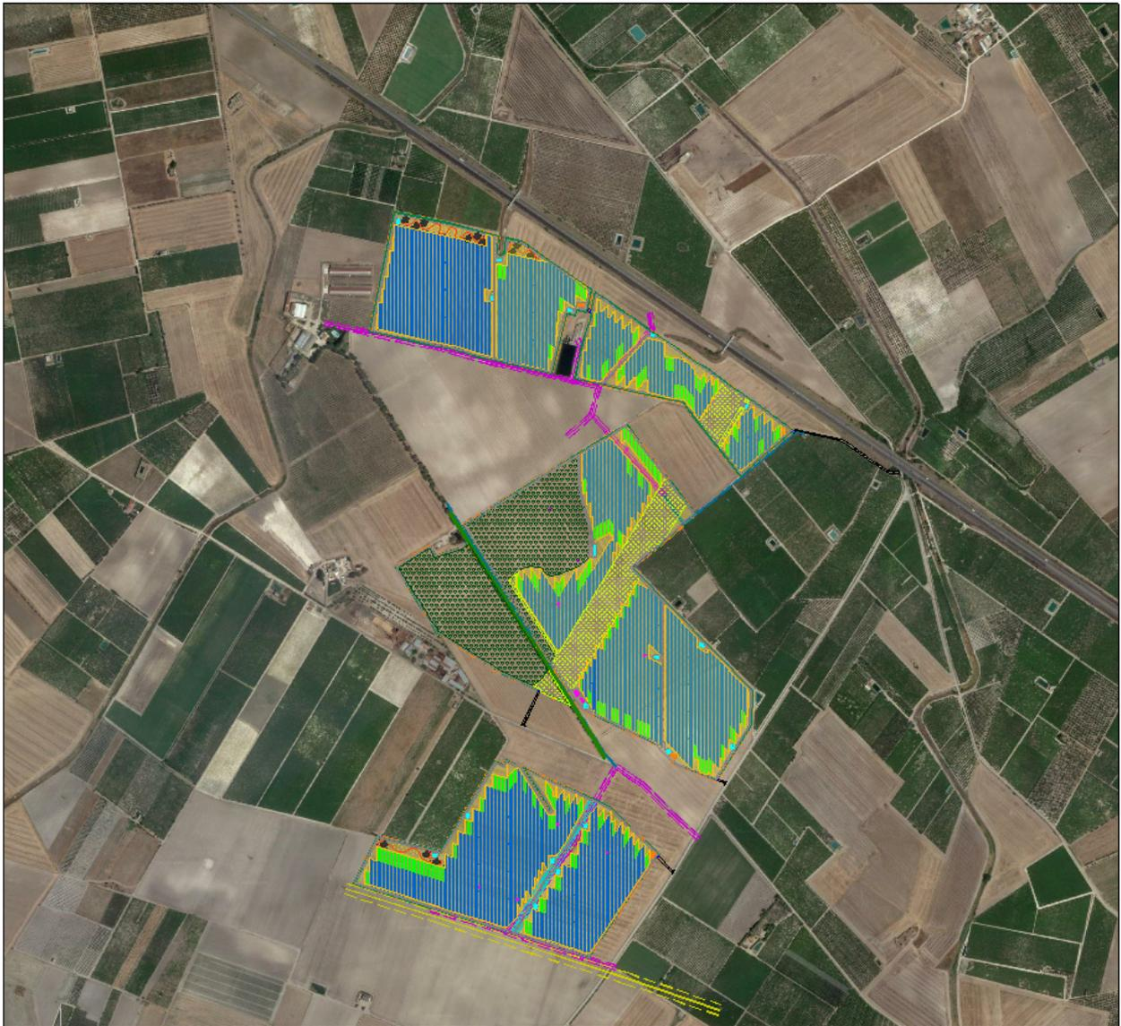
**Figura 4:** Layout impianto con indicazione degli elettrodotti MT/BT esistenti e futuri
