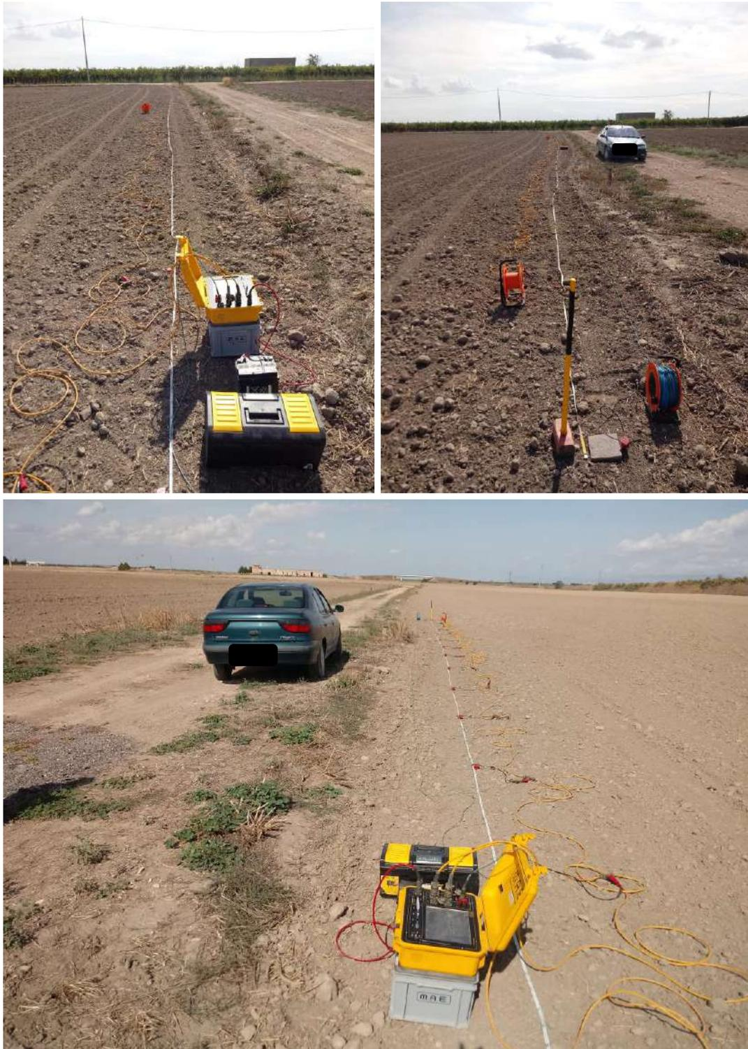
Foto 7, 8 e 9 – Vista dello stendimento sismico e della strumentazione adoperata (S3).
