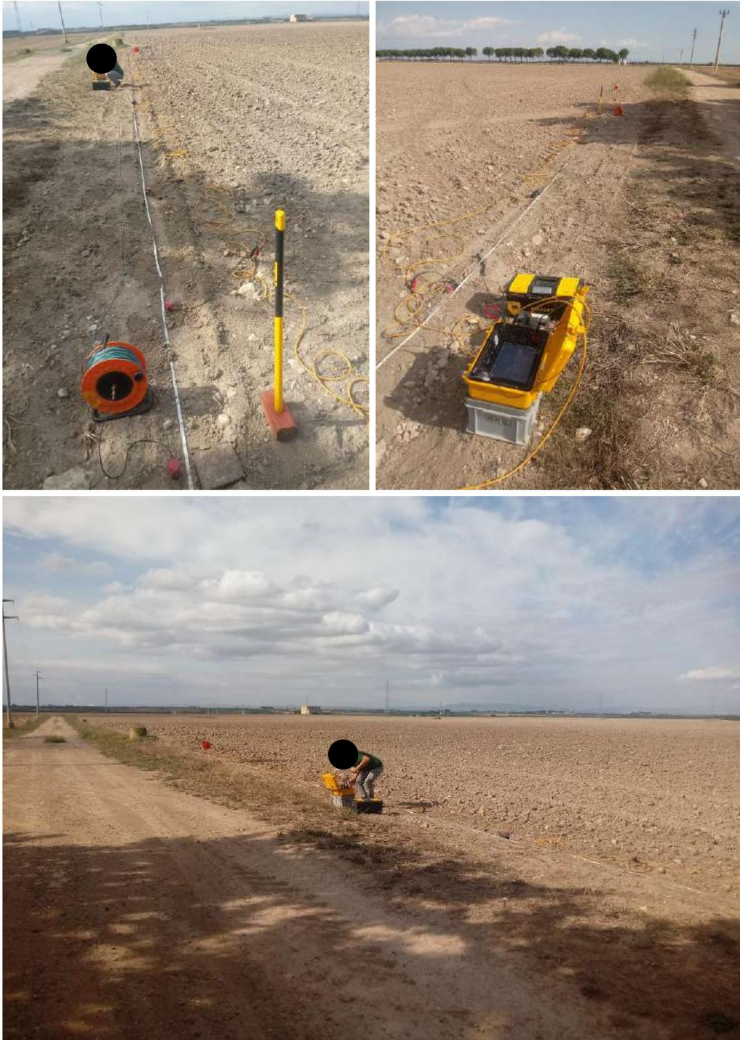
Foto 1, 2 e 3 – Vista dello stendimento sismico e della strumentazione adoperata (S1).
