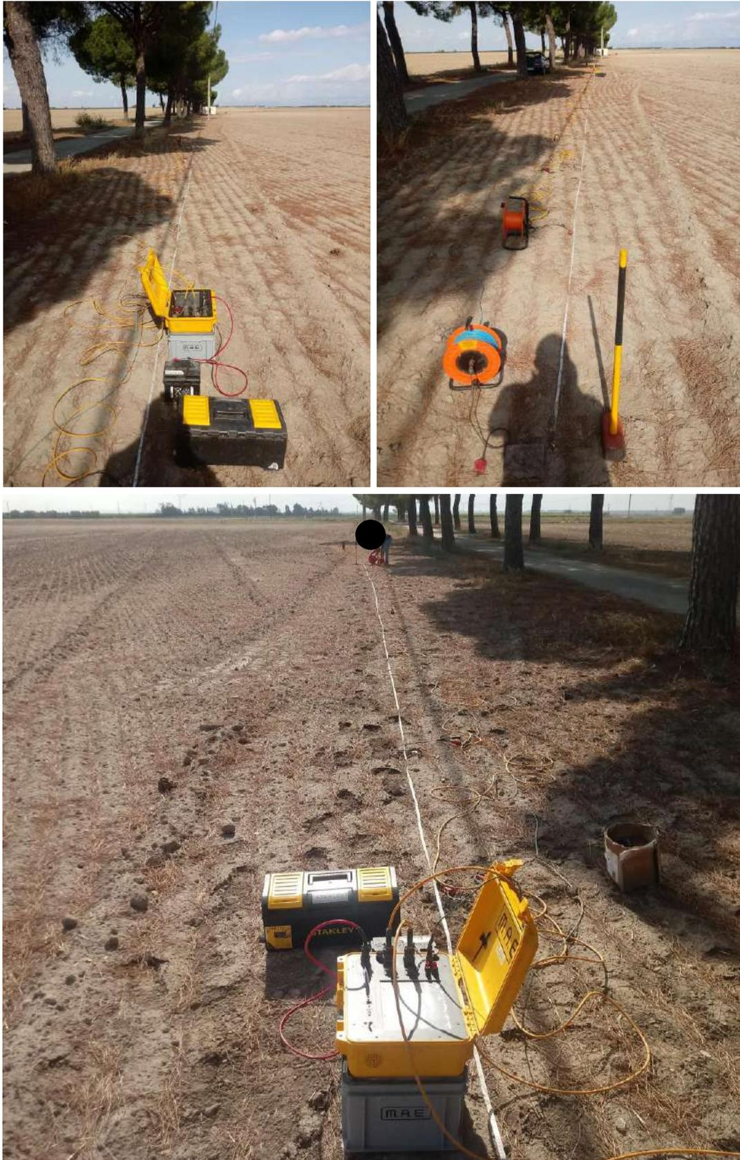
Foto 4, 5 e 6 – Vista dello stendimento sismico e della strumentazione adoperata (S2).
