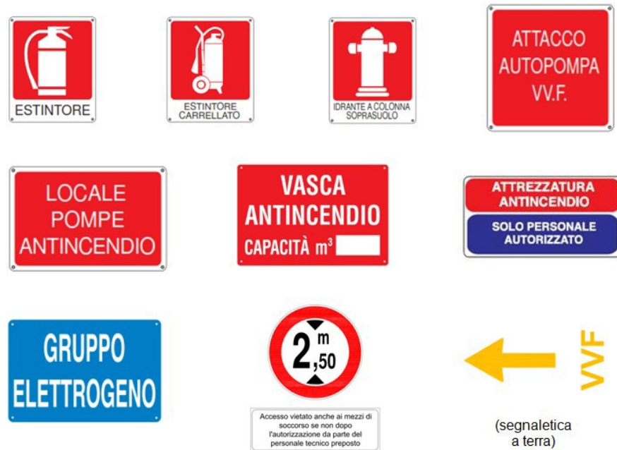
Figura 3 - Esempi di segnaletica di sicurezza
