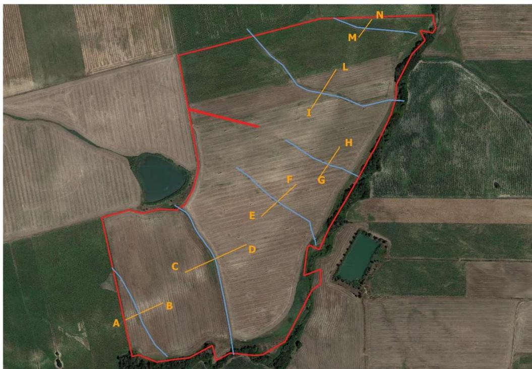
Indicazione delle sezioni trasversali rappresentative tracciate lungo gli affluenti del T. Sapestra.
