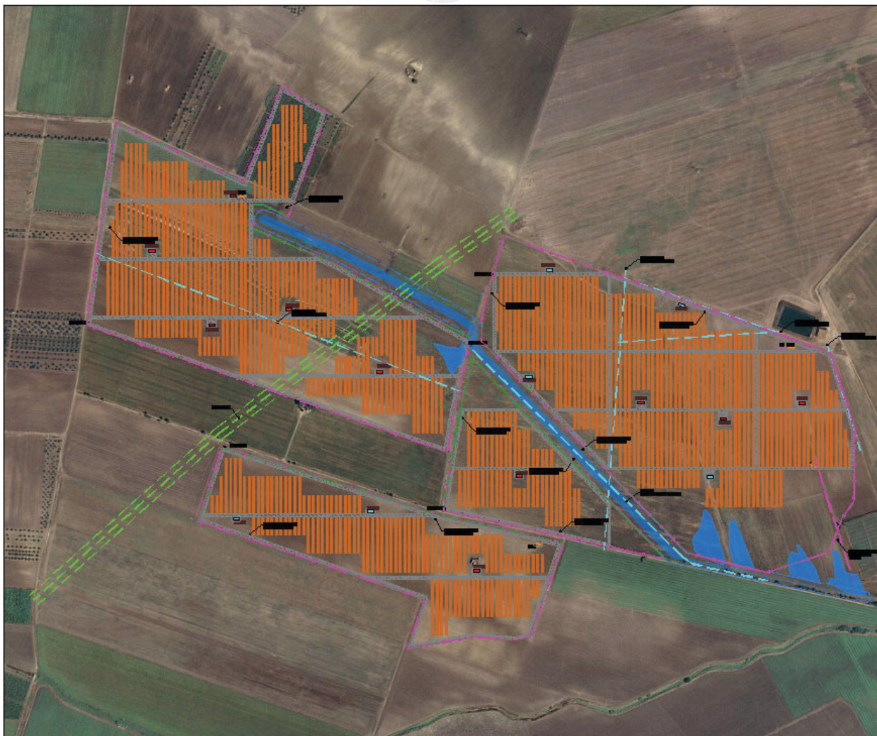
Figura 2: Layout generale su ortofoto della centrale fotovoltaica.
