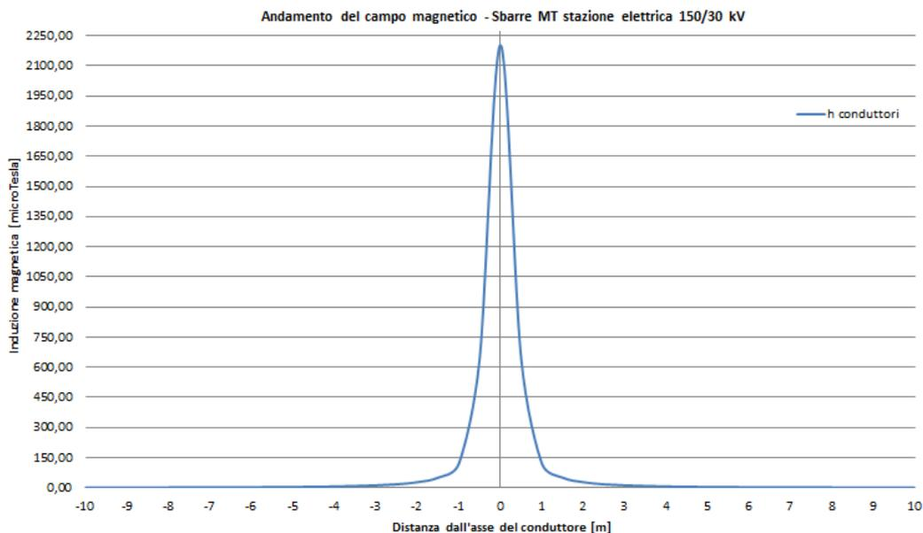
**Figura 3 Andamento del campo magnetico in funzione della distanza dall'asse dei conduttori in forma grafica - Sbarre MT stallo di trasformazione di progetto 30/150 kV - Valutazione della Distanza di prima Approssimazione.**
