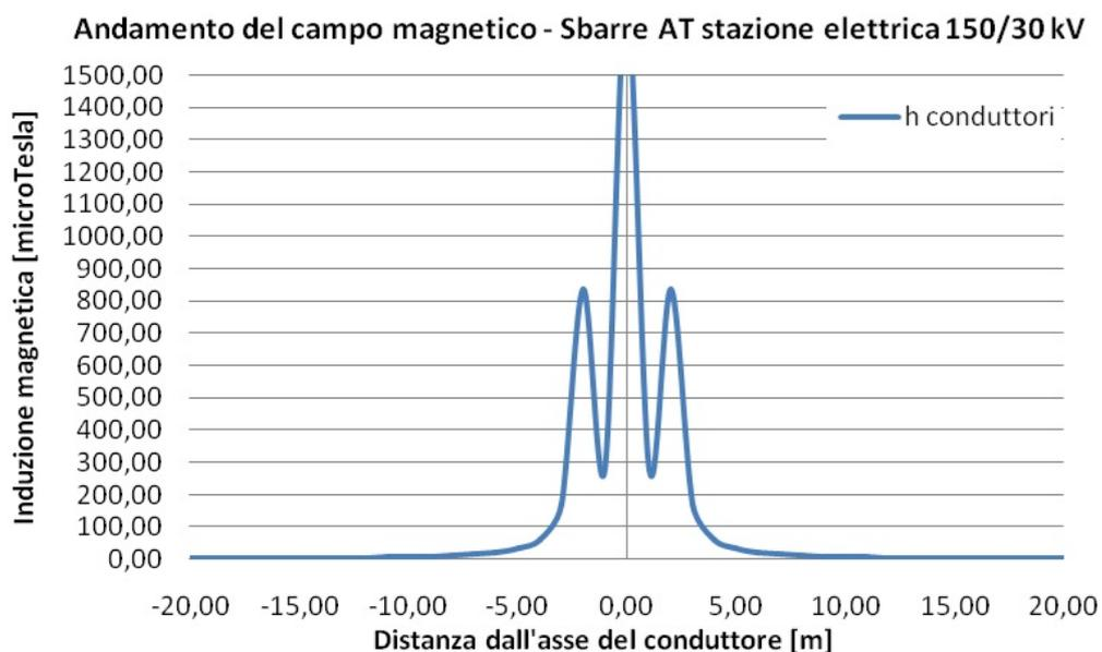
**Figura 2 Andamento del campo magnetico in funzione della distanza dall'asse dei conduttori in forma grafica - Sbarre AT stallo di trasformazione di progetto 30/150 kV - Valutazione della Distanza di prima Approssimazione.**
