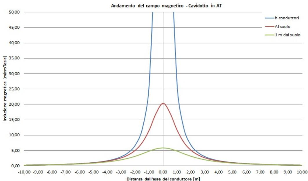
Figura 6 Rappresentazione grafica della DPA cavidotto AT 150 kV.
