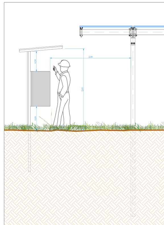
Particolare inverter, sezione A-A, scala 1:20
