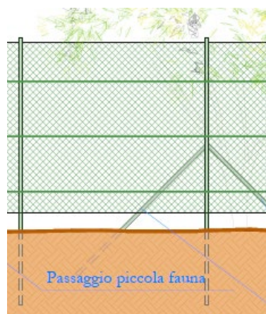
Figura 16 – Prospetto recinzione perimetrale con mitigazione
