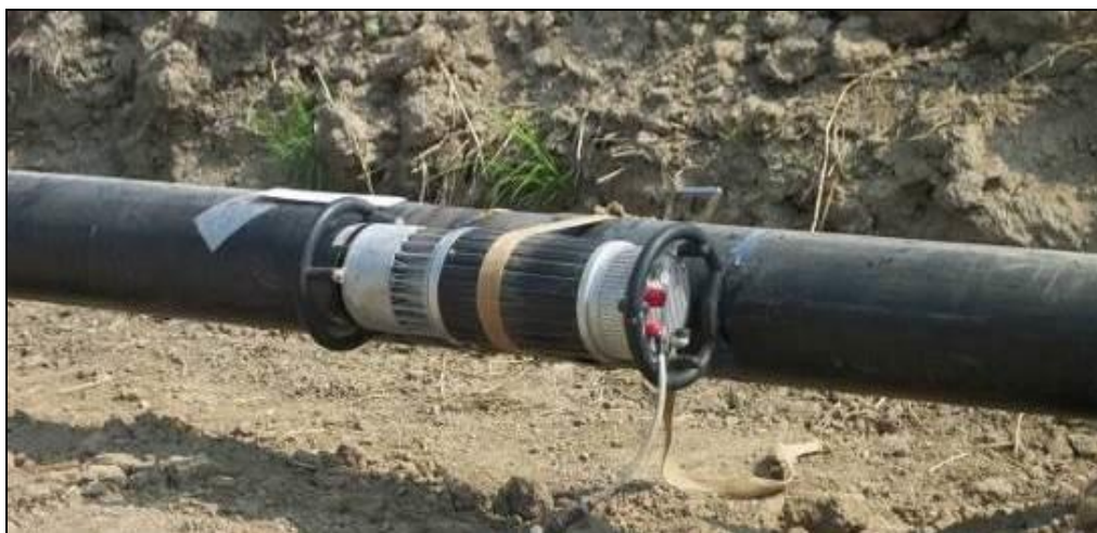
Fig. 9.5/A: Controlli non distruttivi delle saldature
