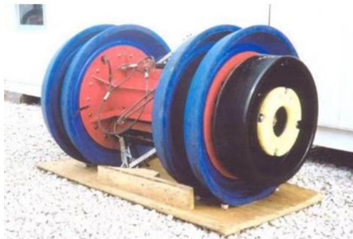
Figura 2.5.5/B PIG strumentale per il controllo della geometria e dello spessore della condotta
