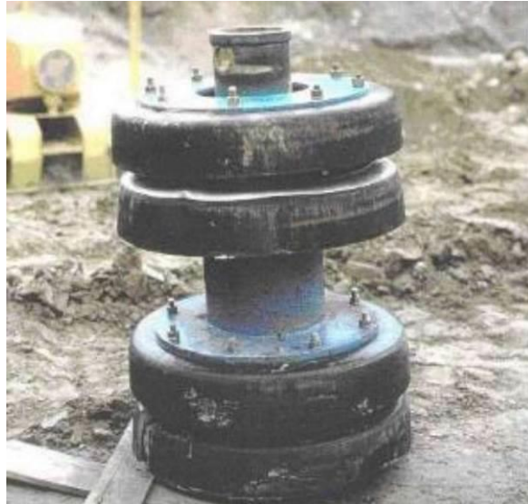
Figura 2.5.5/A PIG convenzionale impiegato in operazioni di collaudo idraulico e pulizia della condotta
