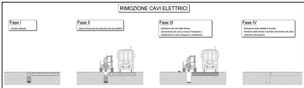
**c) Rimozione completa di tutte le piazzole di montaggio e di tutta la viabilità di servizio avviene secondo la sequenza:**
