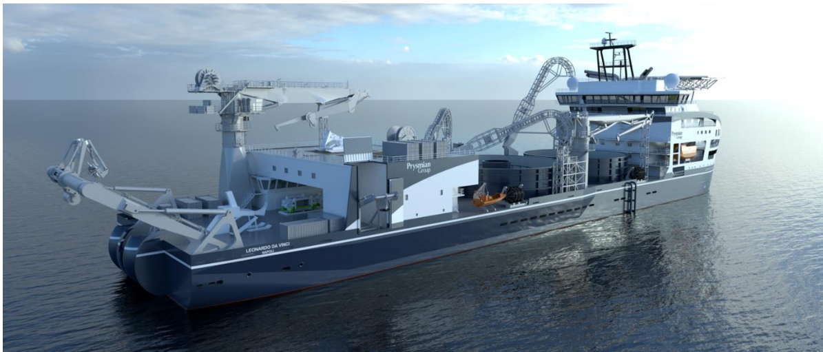
Figura 4-13: Nave posa cavo Leonardo Da Vinci (Fonte: Prysmian Group/Fincantieri)
