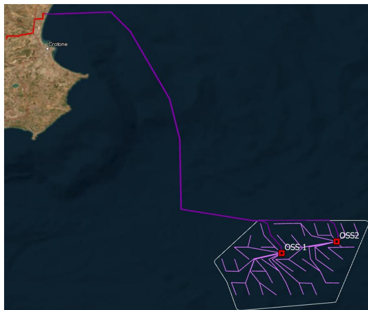
Figura 4-4: Vista del tracciato preliminare del cavidotto marino
