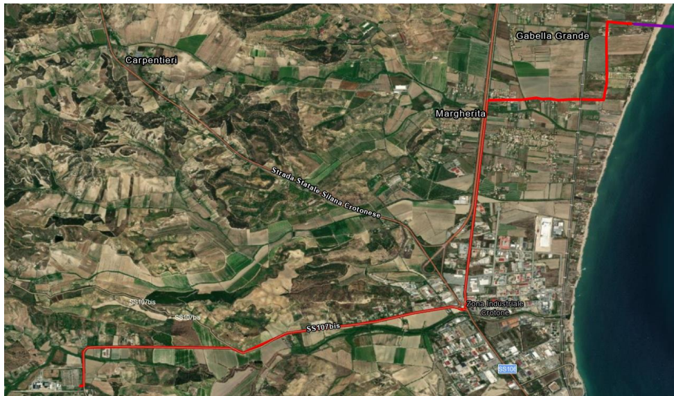
Figura 4-9: Percorso preliminare cavidotto a 220 kV
