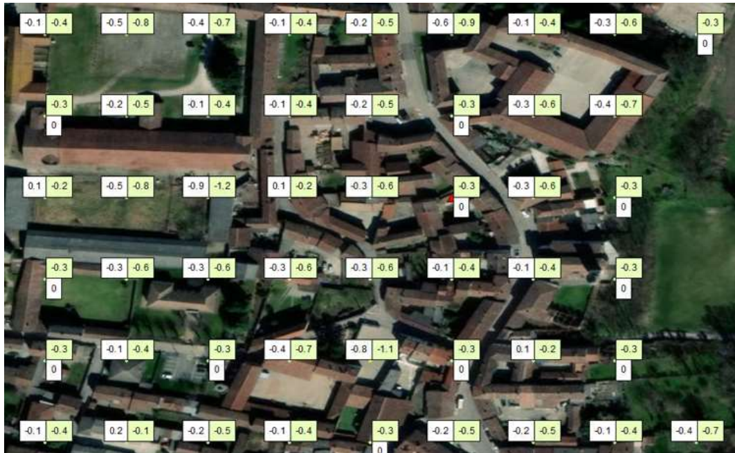
Fig. 31 Visualizzazione del punto di riferimento dell'analisi Local (triangolo rosso) ed indicazione dei valori di velocità verticale originali (in bianco) e calibrati (in verde).
