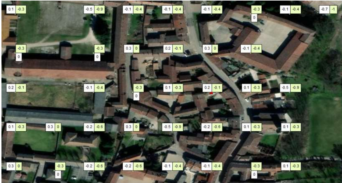
Fig. 20 Visualizzazione del punto di riferimento dell'analisi Local (triangolo rosso) ed indicazione dei valori di velocità verticale originali (in bianco) e calibrati (in verde).
