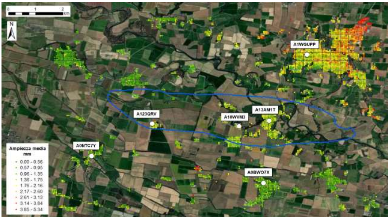
Fig. 39 Dataset Sentinel. Valori medi di ampiezza della stagionalità calcolati per la componente verticale dei PS Local. In figura è visualizzata anche l'ubicazione dei 6 punti scelti per l'analisi delle serie storiche rispetto alla proiezione in superficie del giacimento (si veda Cap. 3.3).
