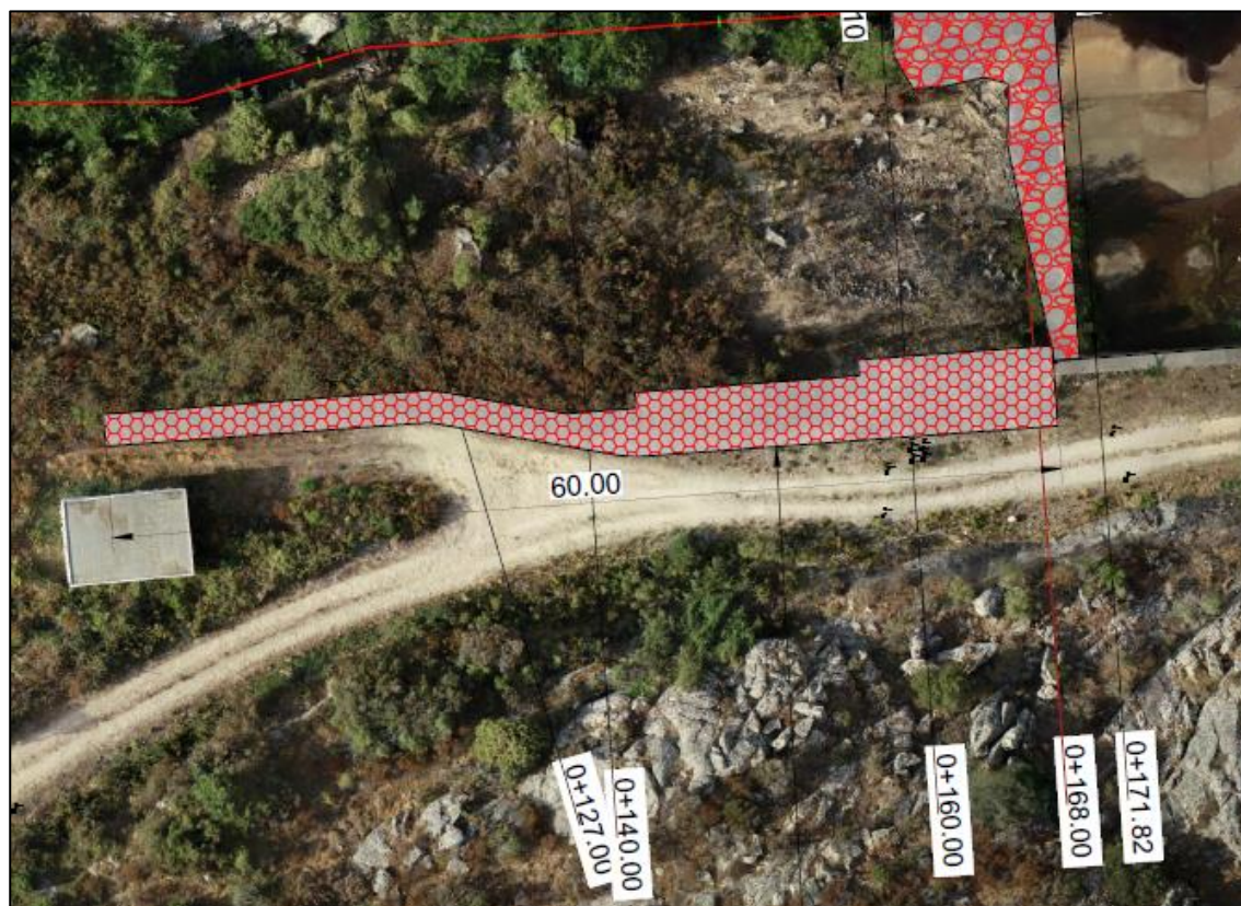
Figura 26 - Intervento con gabbioni metallici
