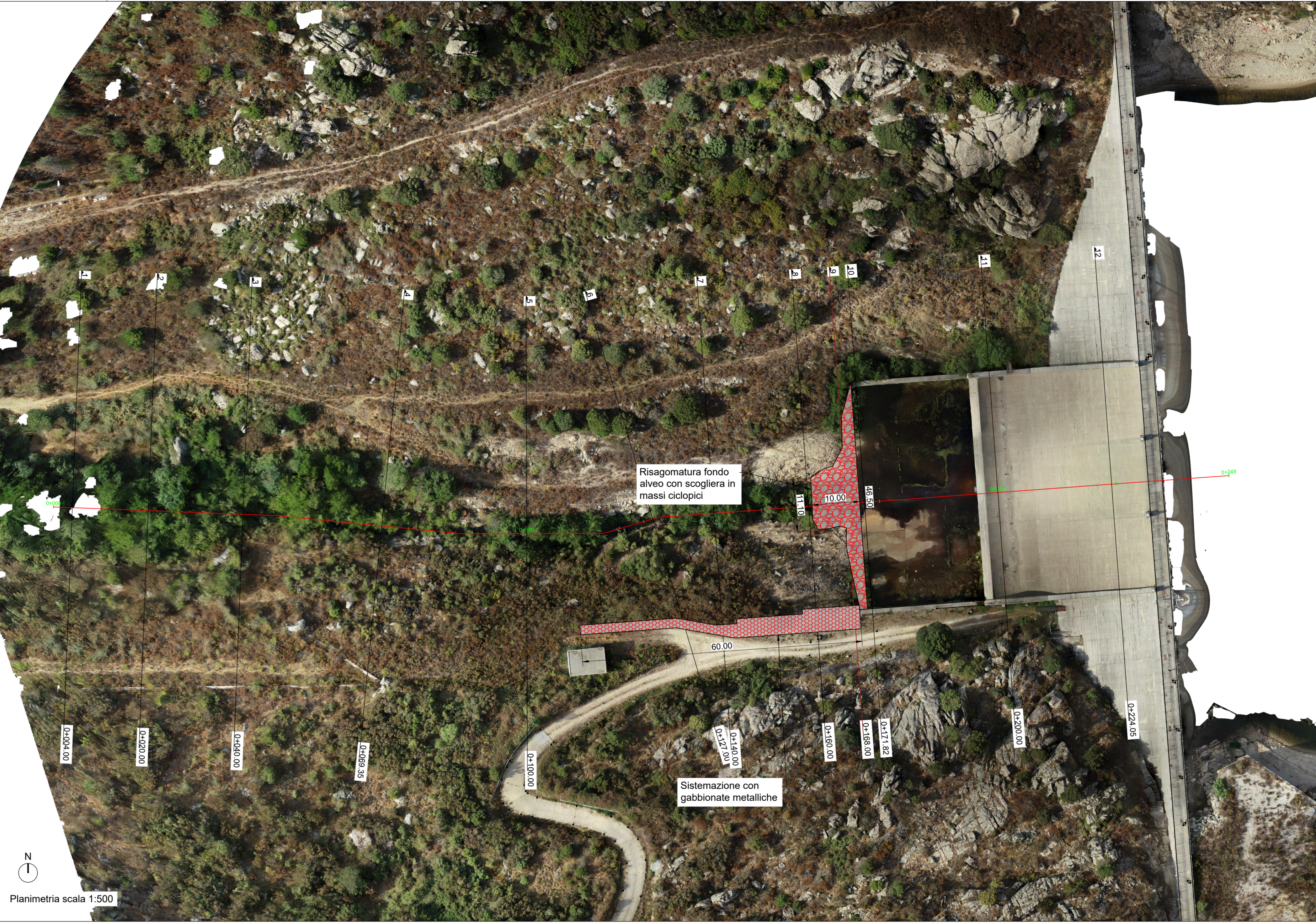
Esempio di risagomatura fondo alveo con scogliera in massi ciclopici
