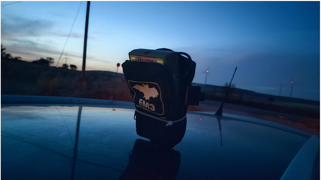
Bat detector ECHO METER EM3 sul tetto dell'auto
