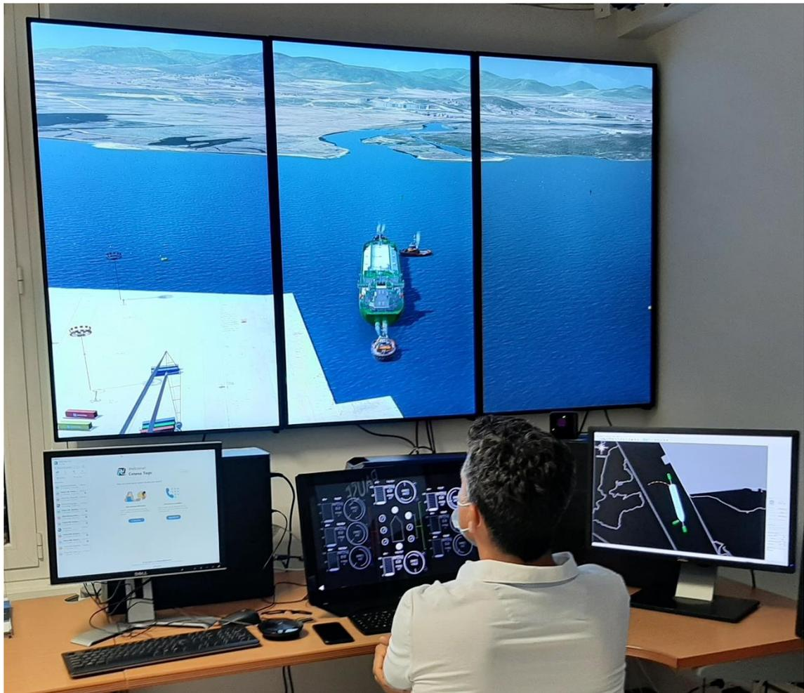
Fig. 4-1 Simulatore MANTA – Durante le prove i rimorchiatori sono stati comandati tramite un touch screen dedicato.
