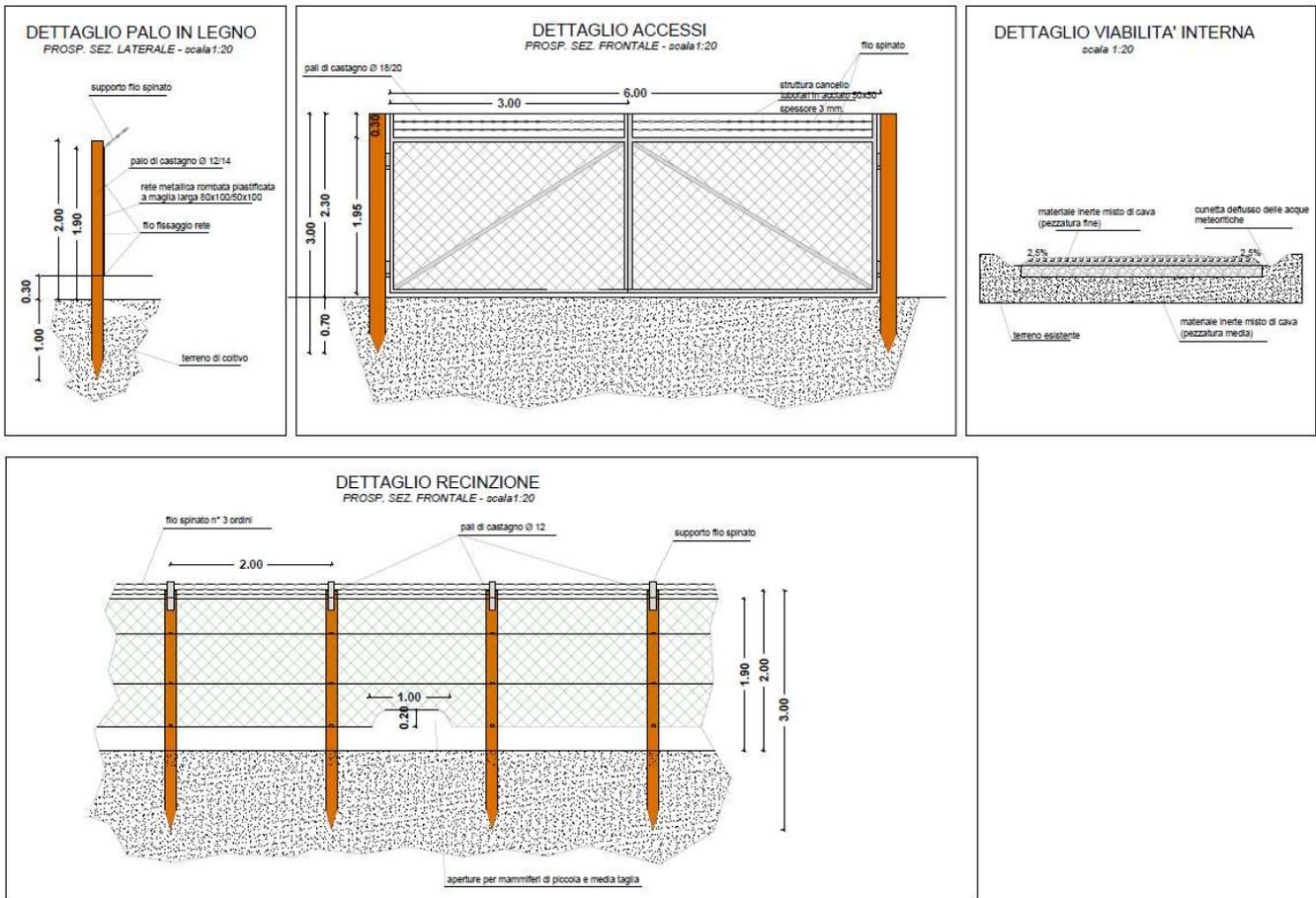
Figura 6 - Dettaglio recinzione, cancello di accesso e viabilità interna
