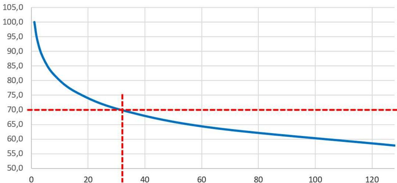
Figura 14 - Livello di pressione sonora in funzione della distanza in metri dalla sorgente
