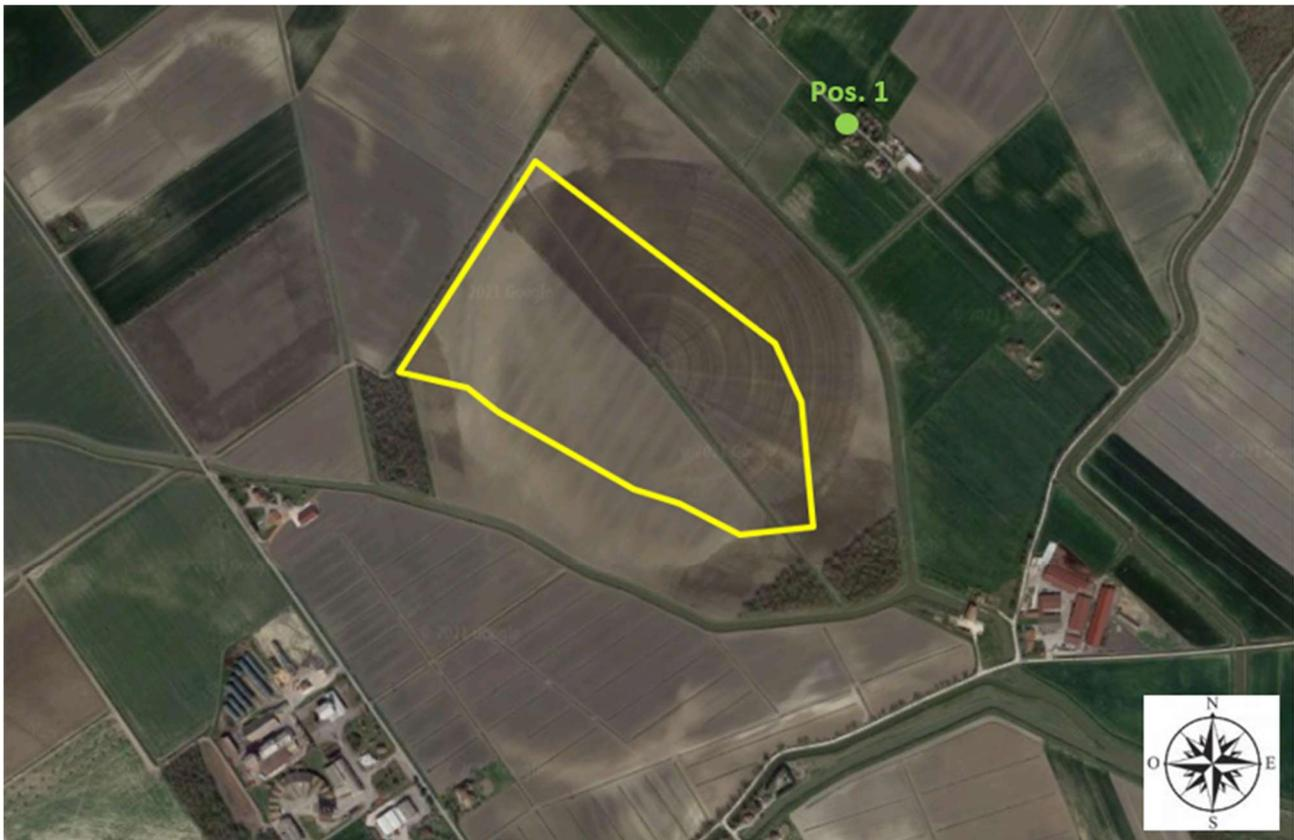
Figura 11 - Posizionamento stazioni di misura della rumorosità residua in EG Dante – Posizioni di misura in verde
