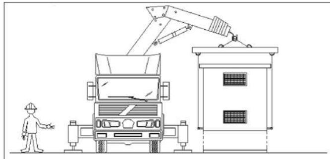
Le caratteristiche della cabina monoblocco consentono la recuperabilità integrale del manufatto con possibilità di poterla spostare e riutilizzare in altro luogo.
