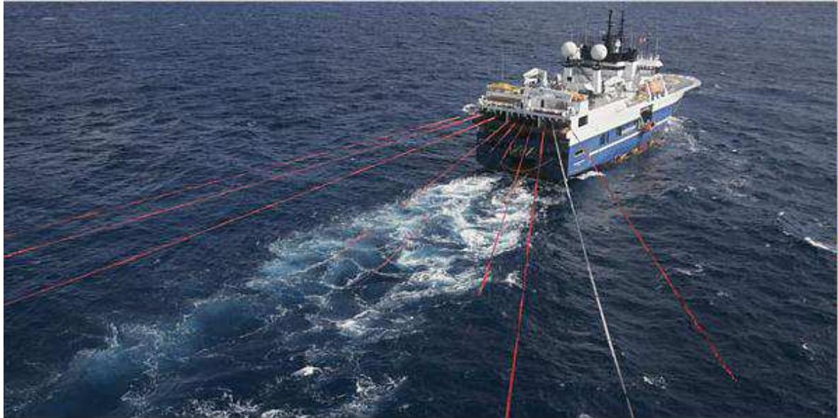
**Figura 4.23 - Esempio di nave per acquisizione sismica in attività. Si possono vedere i cavi per l'acquisizione.**
