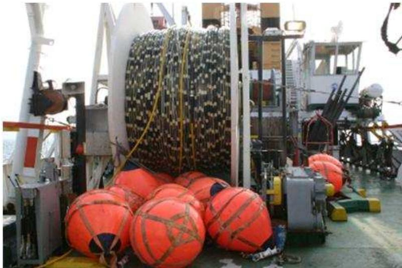
***Figura 4.18 - Cavo per acquisizione sismica***
