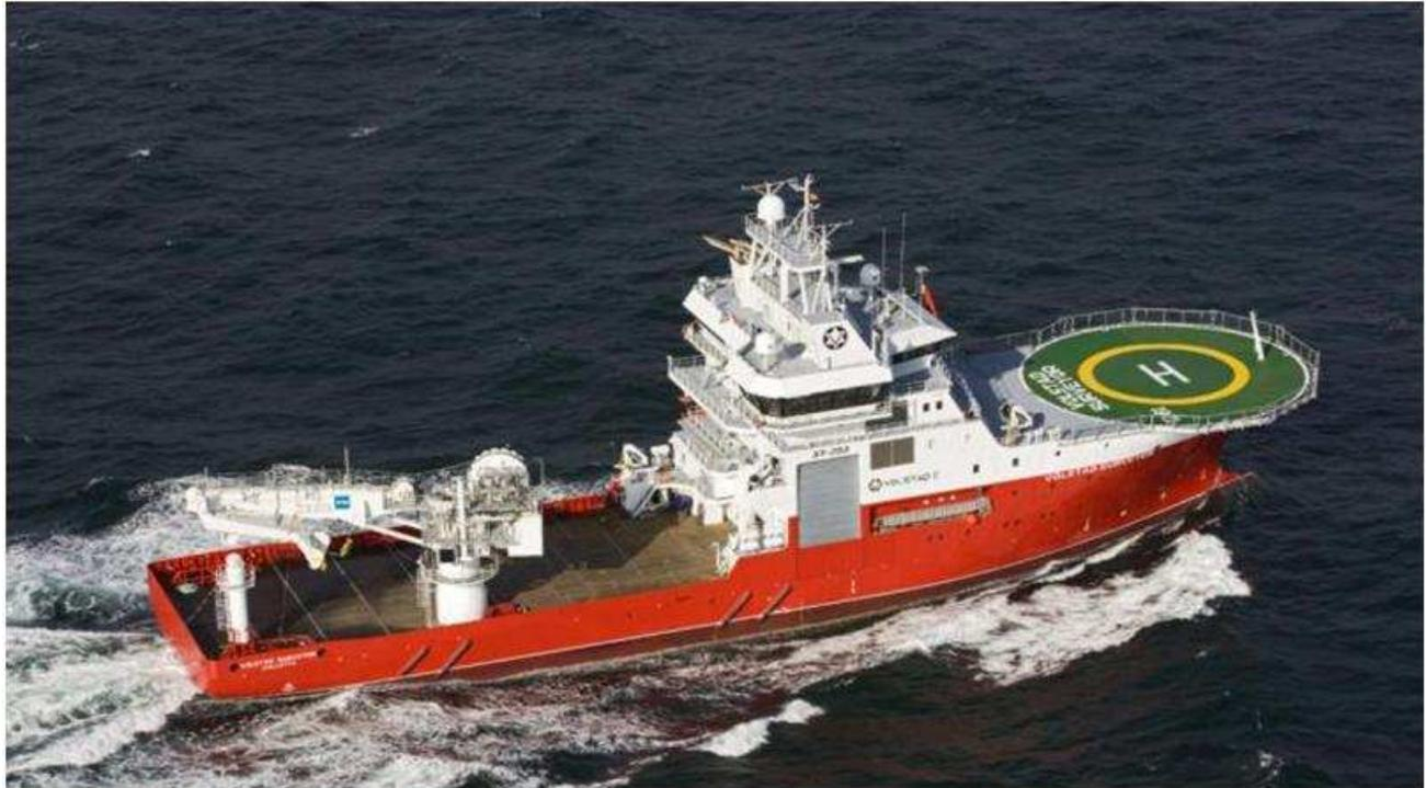
**Figura 4.16 - Esempio di nave per acquisizione sismica (fonte: [www.nauticexpo.it](http://www.nauticexpo.it))**
