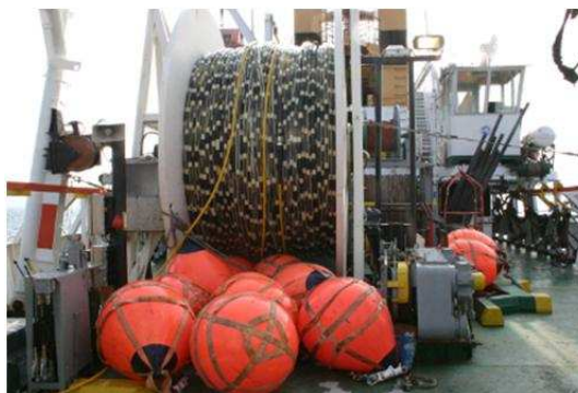
Figura 4.7 - Esempio di una serie di idrofoni usati nella prospezione sismica in mare (fonte: www.oilonline.com ) e di Cavo per acquisizione sismica
