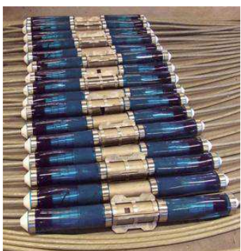
Figura 4.7 - Esempio di una serie di idrofoni usati nella prospezione sismica in mare (fonte: www.oilonline.com ) e di Cavo per acquisizione sismica
