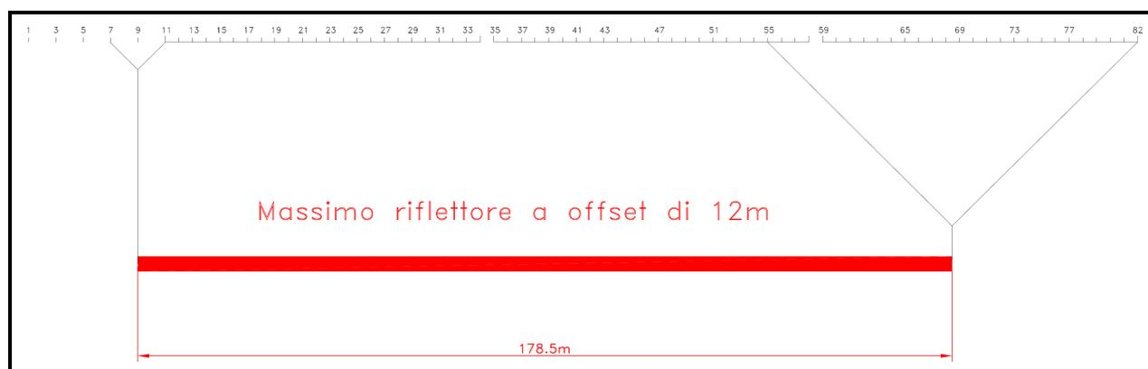
Schema geometrico di acquisizione
