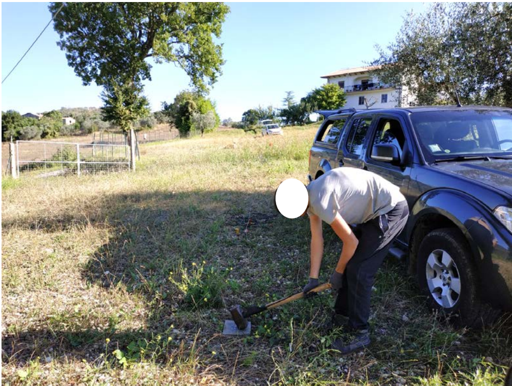
Energizzazione con mazza battente onde longitudinale (Onde P)
