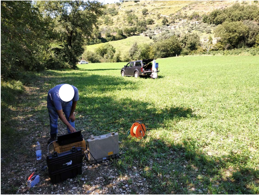
Acquisizione dati misure sismiche
