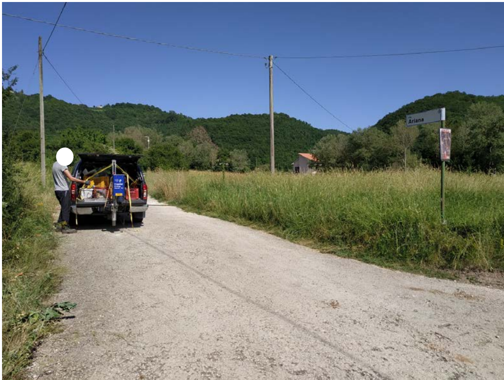
Energizzazione onde longitudinale (Onde P) con generatore ad energia propulsiva di onde sismiche "Peg40"
