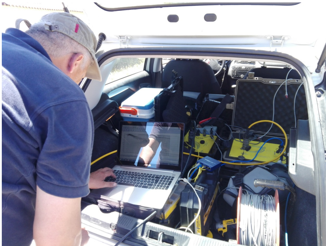
Acquisizione dati misure sismiche
