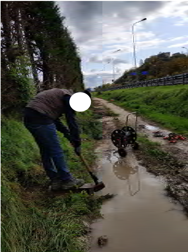
Energizzazione con mazza battente onde trasversali (Onde Sh)-(Profilo 1 sismica a rifrazione)
