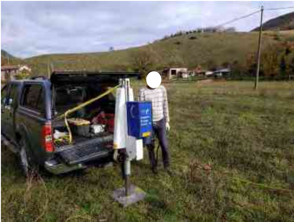
Energizzazione onde longitudinale (Onde P) con generatore ad energia propulsiva di onde sismiche "Peg40" (Profilo 2 sismica a riflessione)
