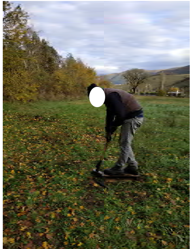
Energizzazione con mazza battente onde longitudinale (Onde P)- (Profilo 6 sismica a rifrazione)
