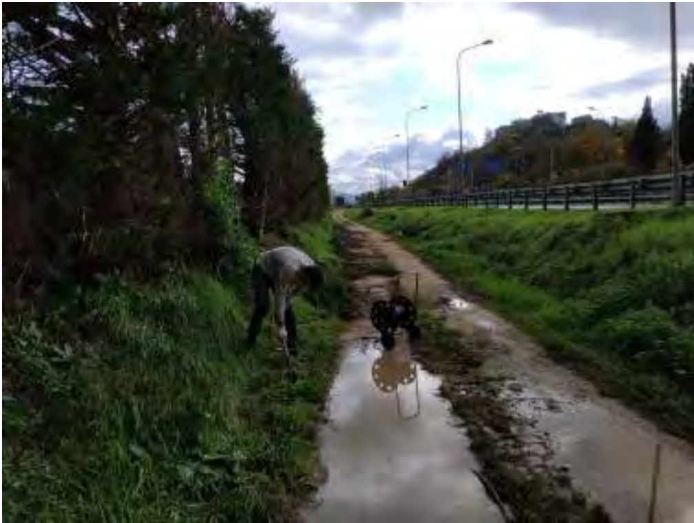
Energizzazione con mazza battente onde longitudinale (Onde P)- (Profilo 1 sismica a rifrazione)
