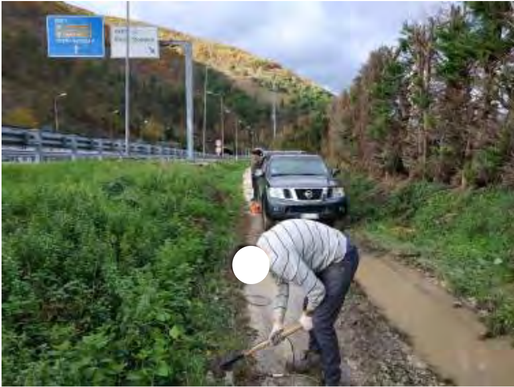
Energizzazione con mazza battente onde longitudinale (Onde P)-(Profilo 2 sismica a rifrazione)
