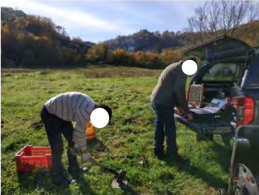
Energizzazione con mazza battente onde longitudinale (Onde P)- (Profilo 7 sismica a rifrazione)
