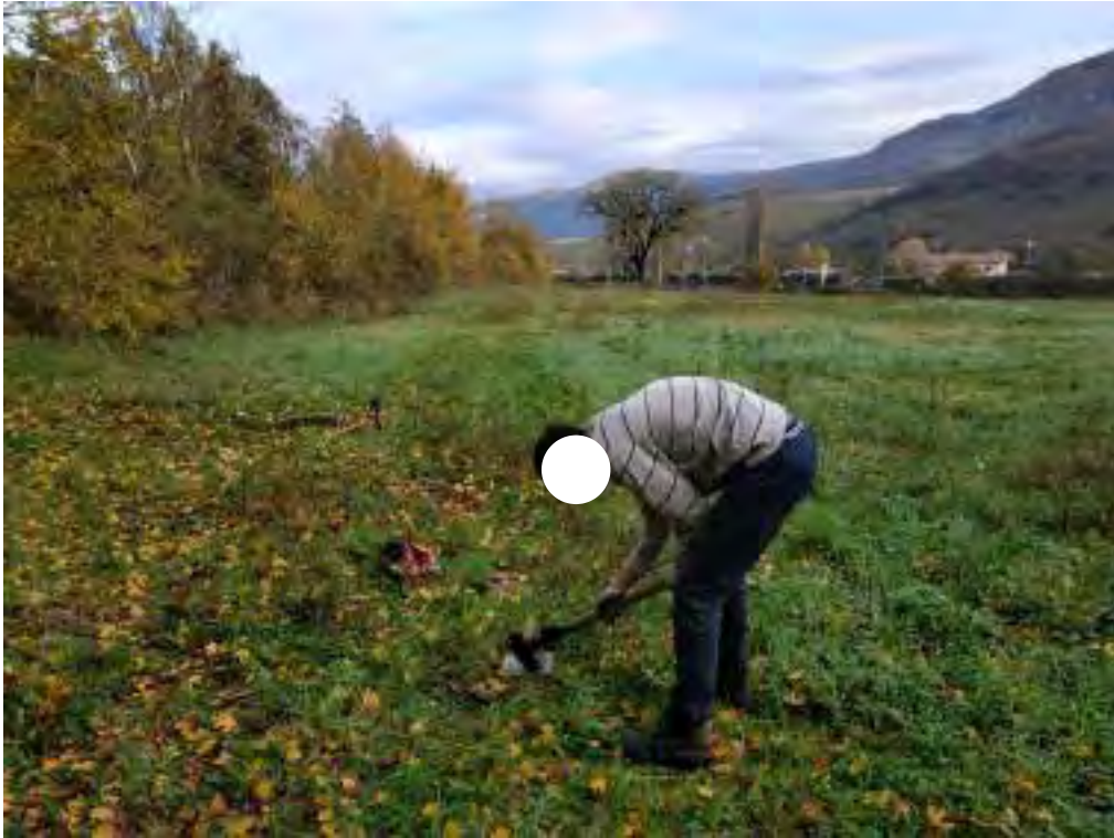
Energizzazione con mazza battente onde longitudinale (Onde P)- (Profilo 6 sismica a rifrazione)
