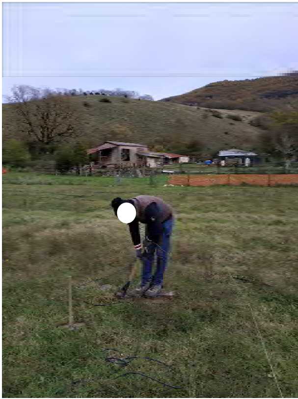
Energizzazione con mazza battente onde trasversali (Onde Sh)-(Profilo 3 sismica a rifrazione)
