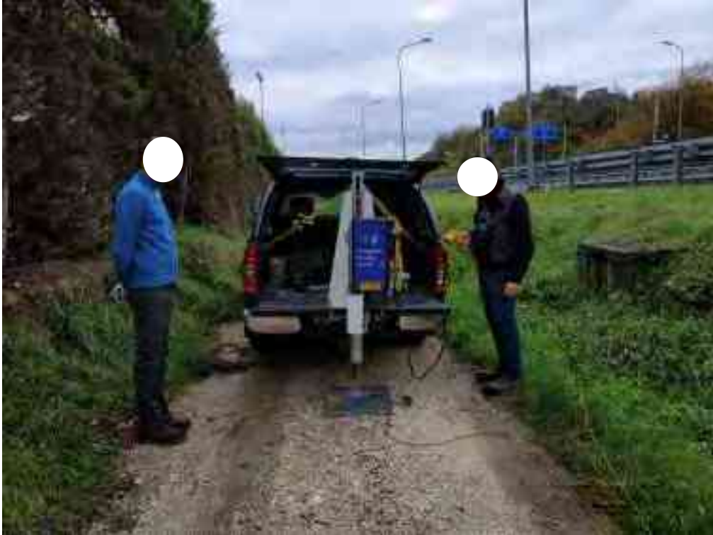
Energizzazione onde longitudinale (Onde P) con generatore ad energia propulsiva di onde sismiche "Peg40" (Profilo 1 sismica a riflessione)
