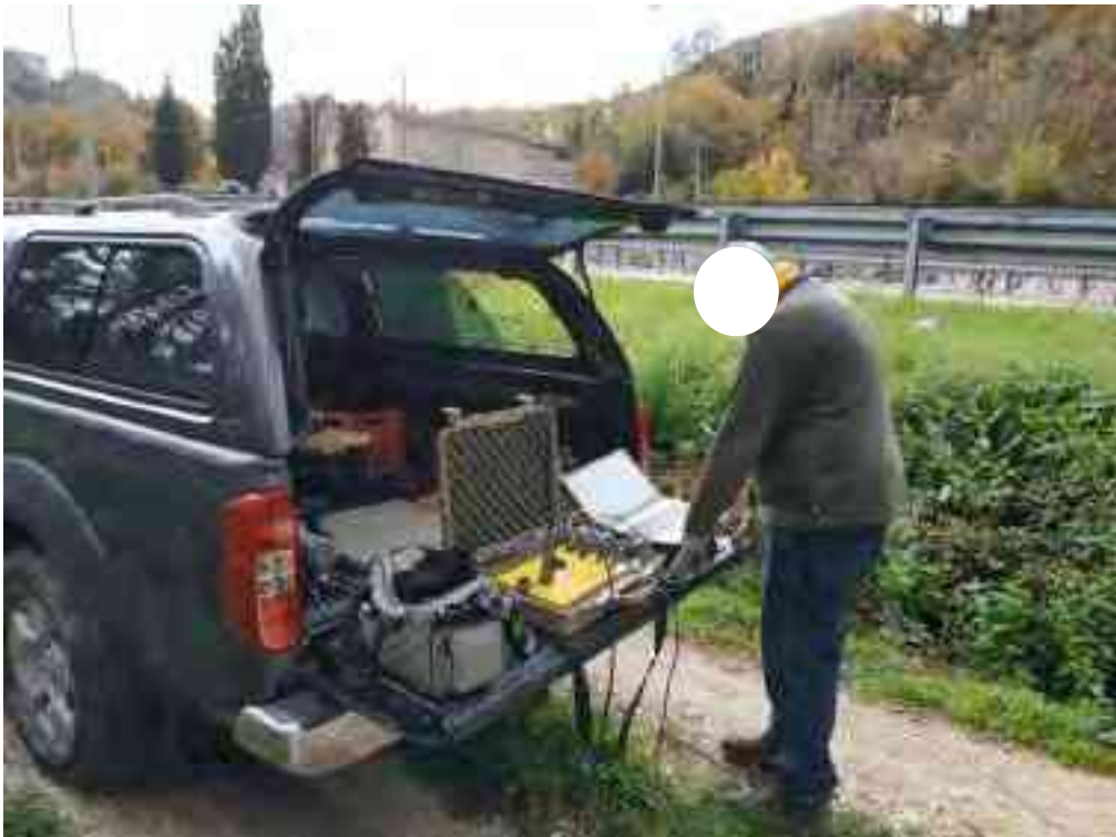
Acquisizione dati misure sismiche (Profilo 1 sismica a riflessione)
