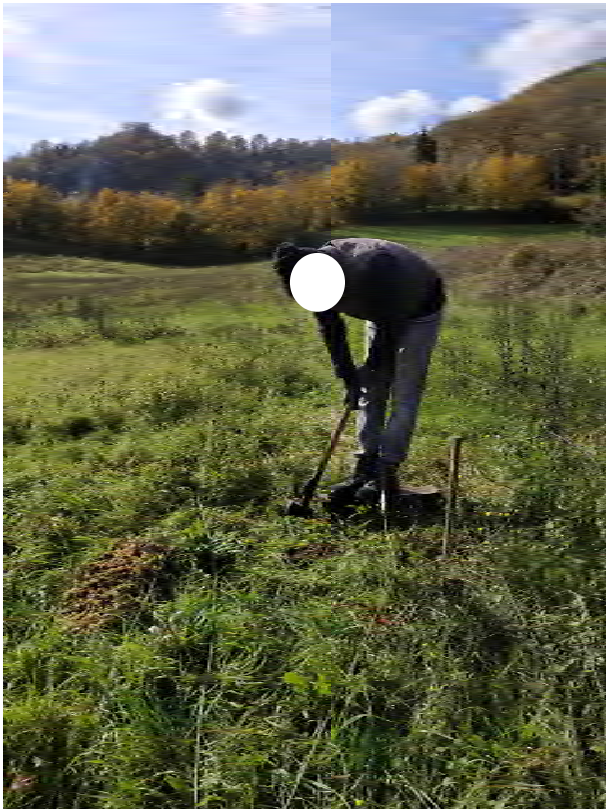
Energizzazione con mazza battente onde trasversali (Onde Sh)-(Profilo 7 sismica a rifrazione)
