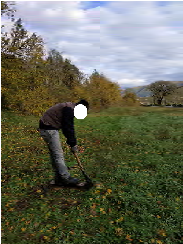
Energizzazione con mazza battente onde trasversali (Onde Sh)-(Profilo 6 sismica a rifrazione)
