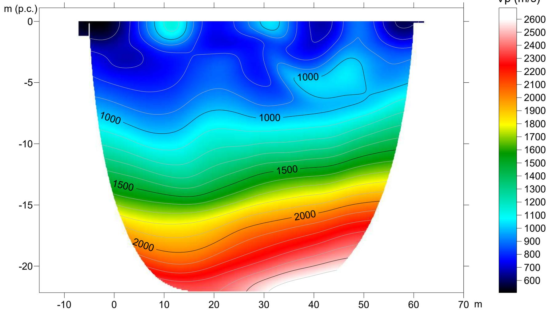
Sismica tomografica a rifrazione "Turano Monte"
