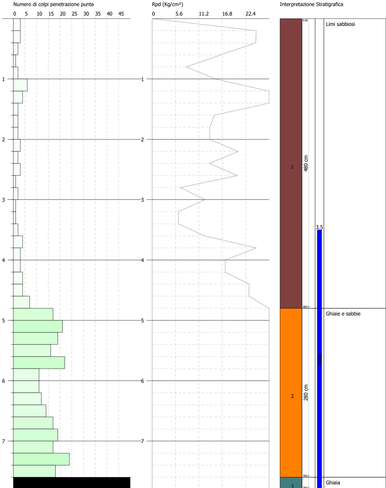
**PROVA PENETROMETRICA DINAMICA DPSH8**
