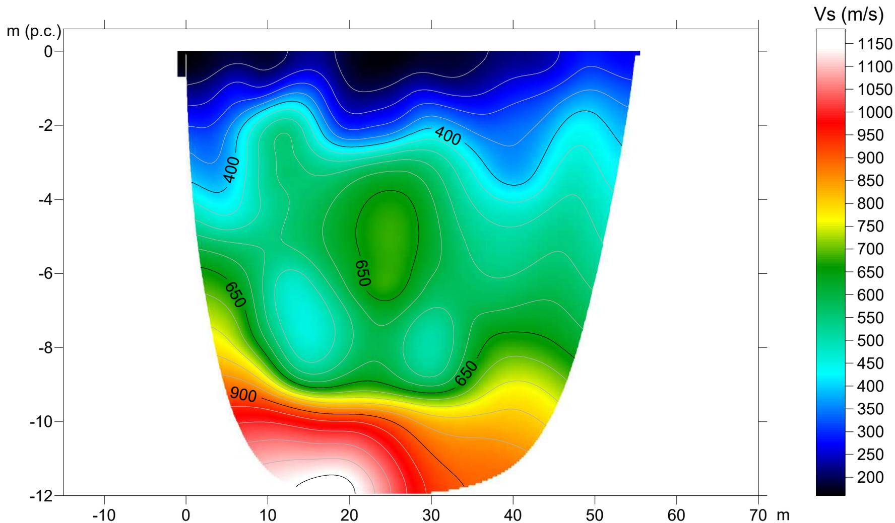
Sismica tomografica a rifrazione "Turano Valle"
