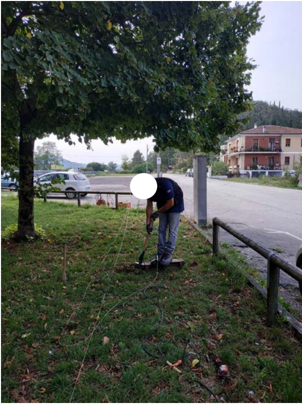
Energizzazione con mazza battente onde trasversali (Onde SH) profilo 2
