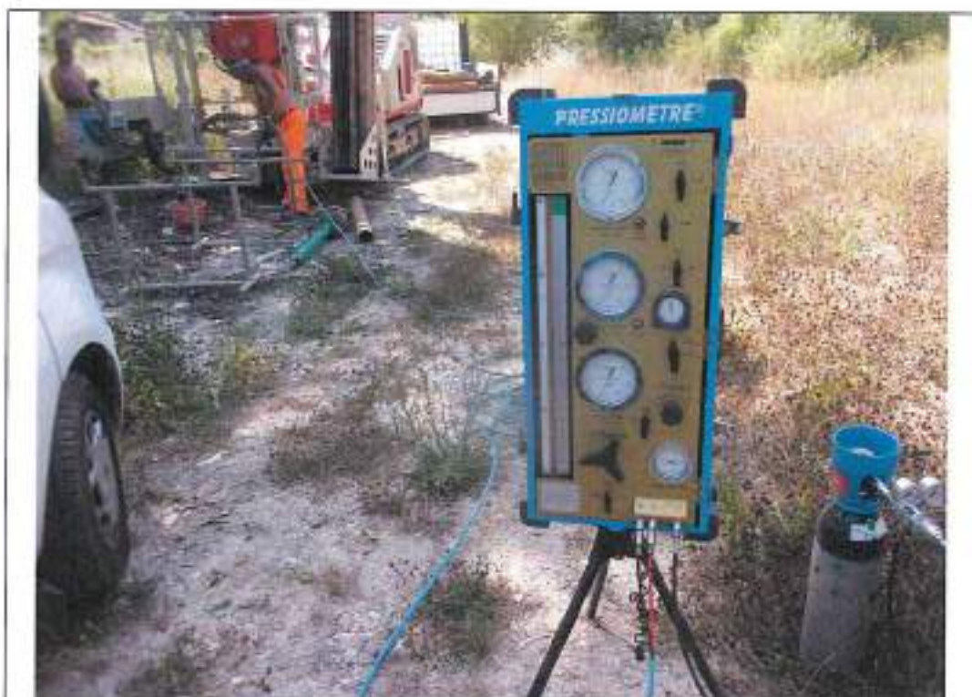
Esecuzione prove pressiometriche in sondaggio S6
