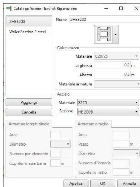
Figura 14.28 – Inserimento trave di ripartizione in Paratie
