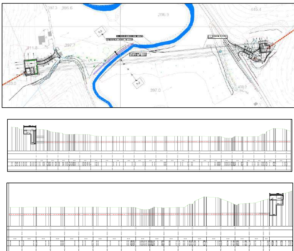
Figura 3.3 – Planimetria e profilo di attraversamento della piana del Turano.
