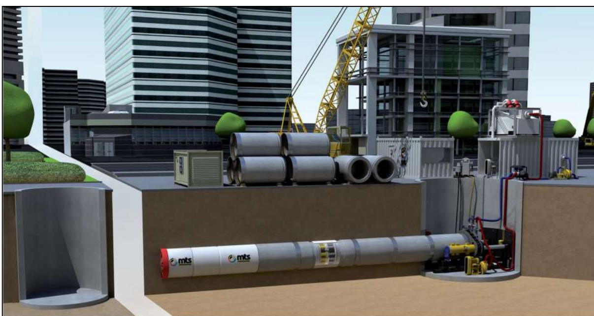
Figura 5.2 - Cantiere Microtunnelling (immagine ricavata da brochure MTS Perforator GMBH)
