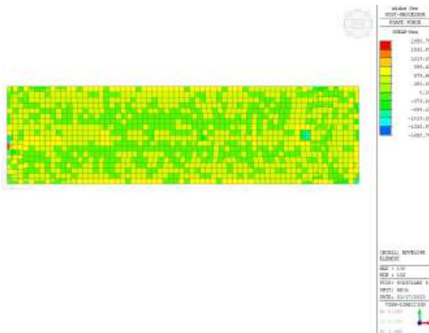
Figura 34 – Taglio Max fondazione inviluppo SLU/SLV [KN/m]
