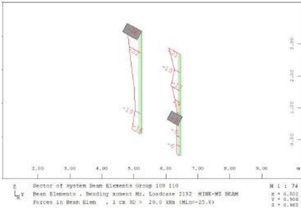
Figure 4-167: –Minimo momento direzione x SLU/SLV
