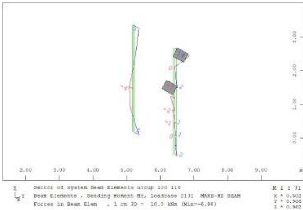
Figure 4-168: – Massimo momento direzione x SLU/SLV
