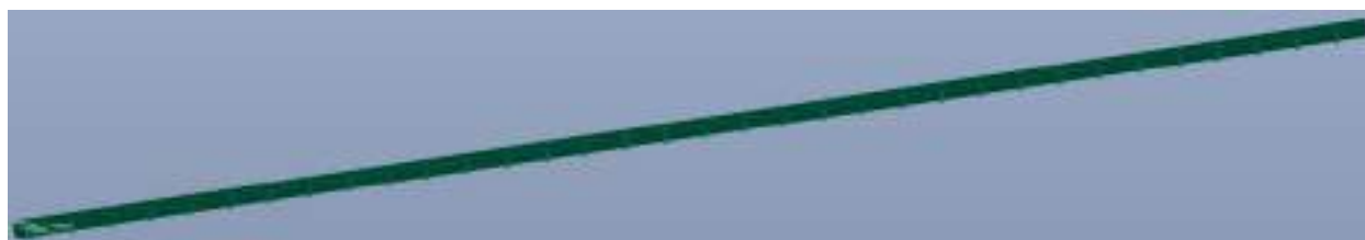
Figura 10.6 – Modello FEM per verifiche strutturali – L_{tot} = 300\text{ m} | Appoggi 9 m
