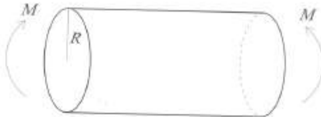
Figura 3.33: Ovalizzazione di un tubo per effetto di un momento flettente agente alle estremità.
