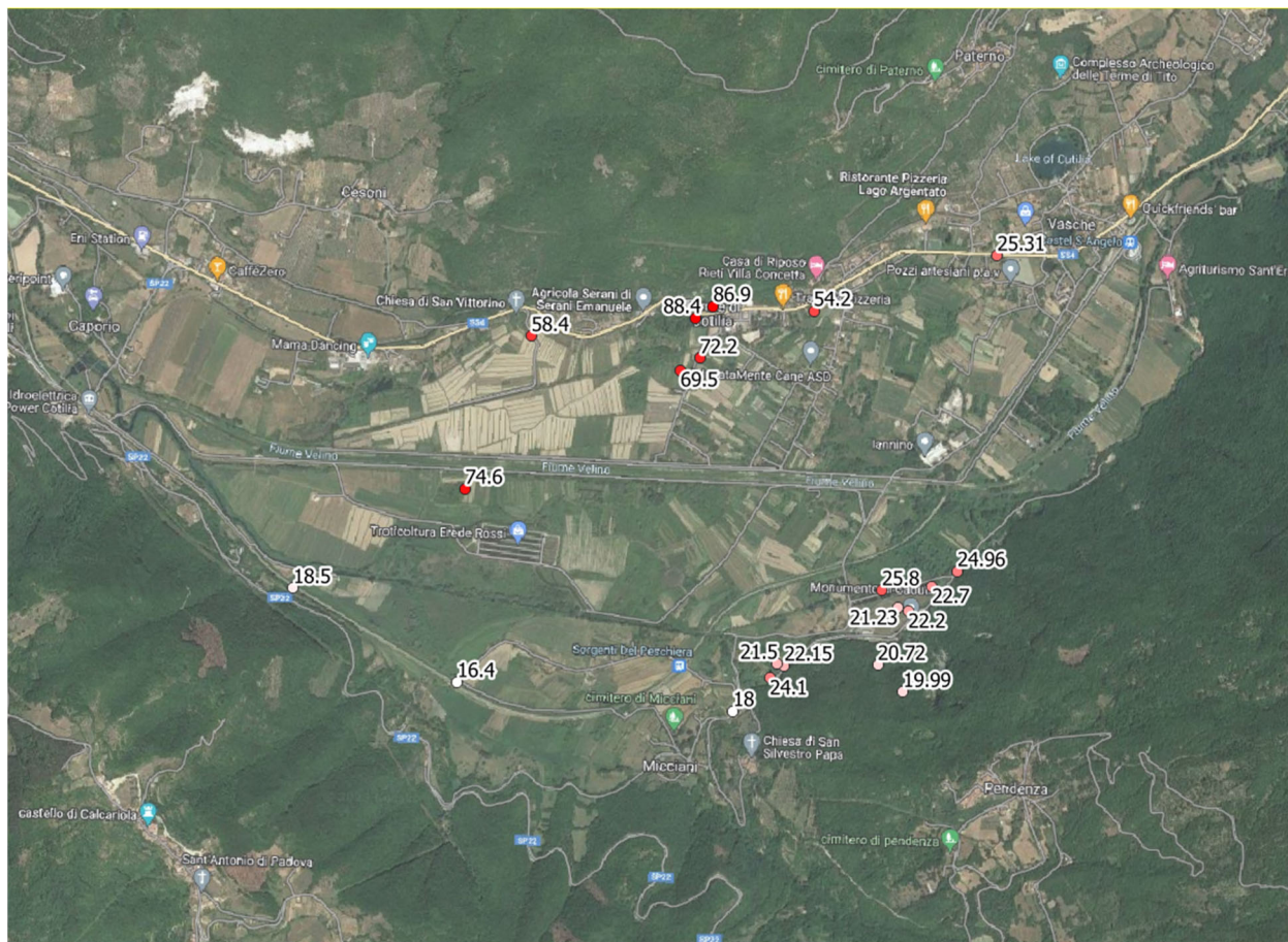
Figura 4.21 – Valori delle concentrazioni di magnesio Mg ++ [mg/L] nelle acque di falda attraversate lungo la piana di San Vittorino dal tracciato di progetto
