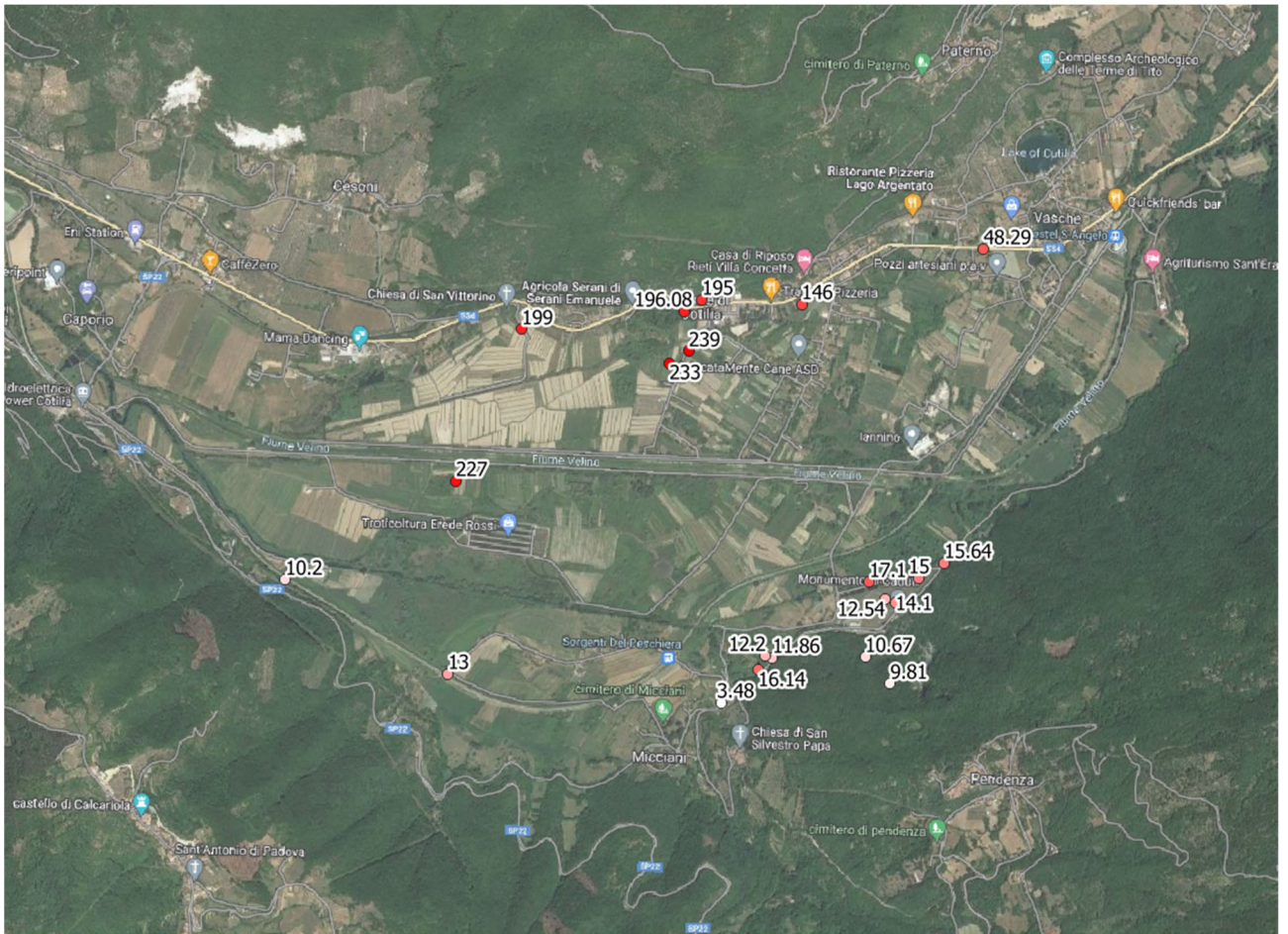
Figura 4.20 – Valori delle concentrazioni di solfati SO_4^{2-} [mg/L] nelle acque di falda attraversate lungo la piana di San Vittorino dal tracciato di progetto
