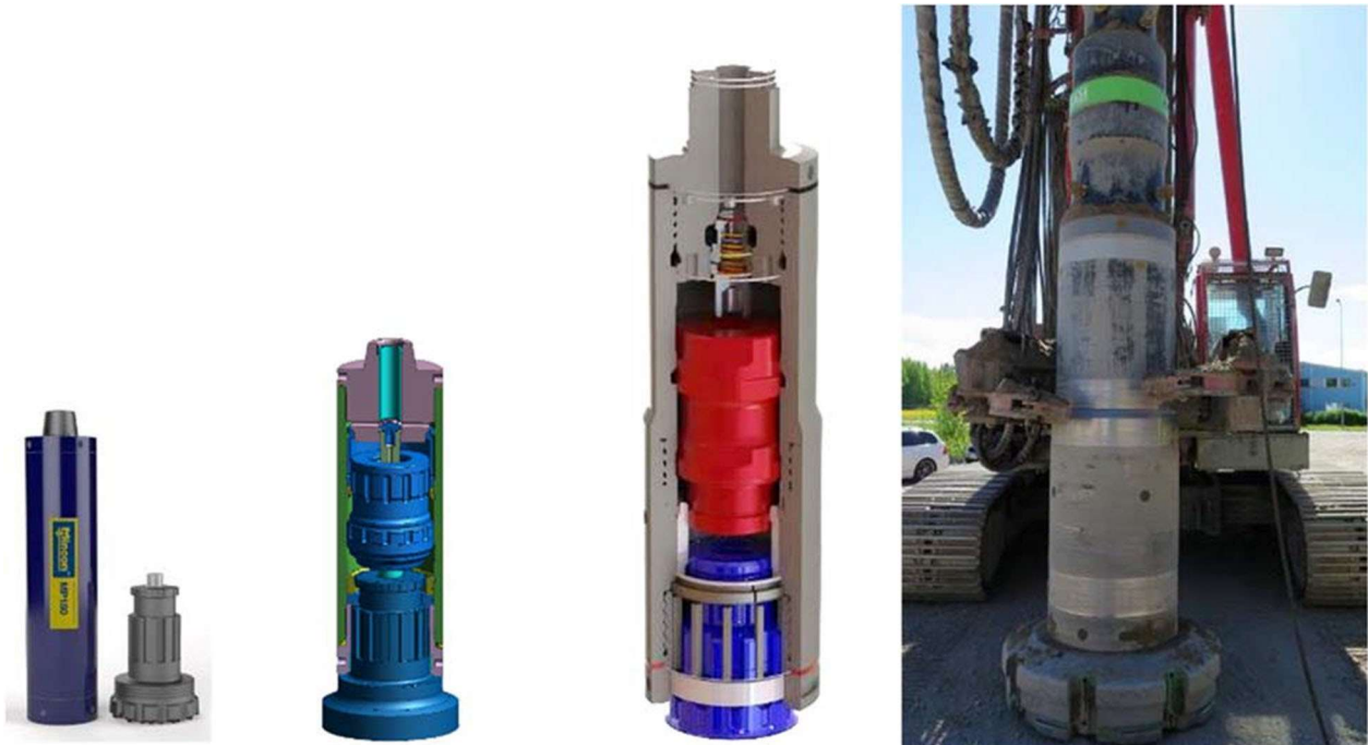
Figura 3.4 - Elementi di composizione del martello fondoforo e della "scarpa a perdere"
