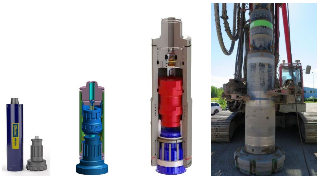
Figura 7.4 - Elementi di composizione del martello fondoforo e della "scarpa a perdere"
