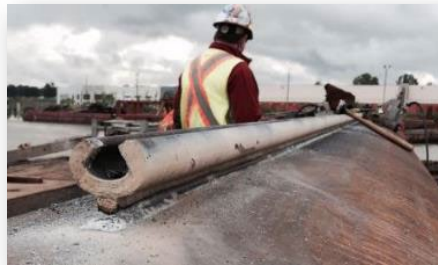
Figura 7.6 - Gargame ad omega durante la fase di saldatura lungo il fusto del lamierino.
