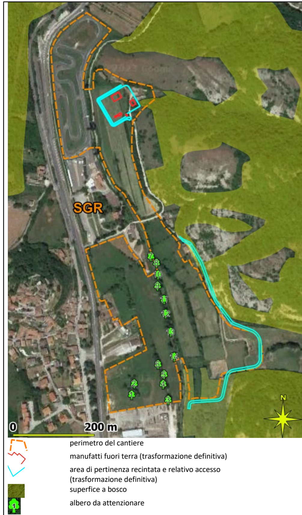
Figura 4.5.1c Rappresentazione della superficie a bosco e ubicazione degli alberi da attenzionare presso l'area del cantiere principale di San Giovanni Reatino (base Google Earth, giugno 2022)
