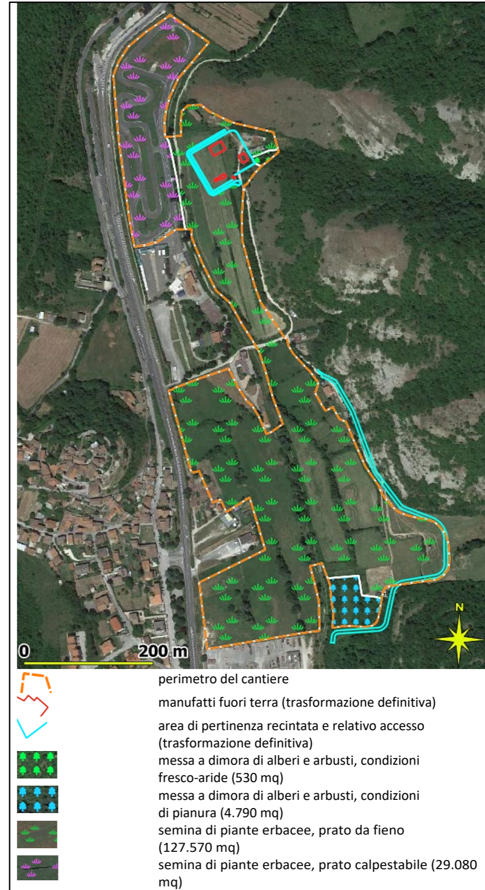
Figura 4.5.1d Ripristino naturalistico-ambientale presso l'area del cantiere principale di San Giovanni Reatino
